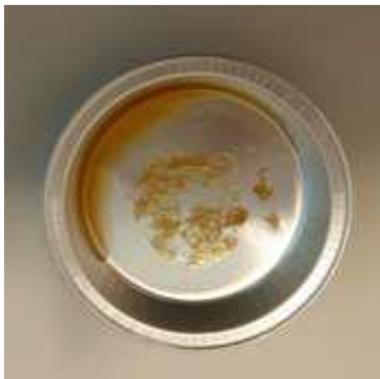
**Figura 3.1a:** Resina e fotoiniziatore (5% in peso), dopo esposizione alla luce UV con intensità 8 mW/cm<sup>2</sup> e tempo = 15 minuti
