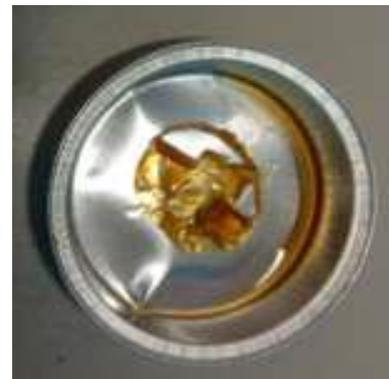
**Figura 3.1b:** Resina e fotoiniziatore (5% in peso), dopo esposizione alla luce UV con intensità di 40 mW/cm<sup>2</sup> e tempo = 5 minuti
