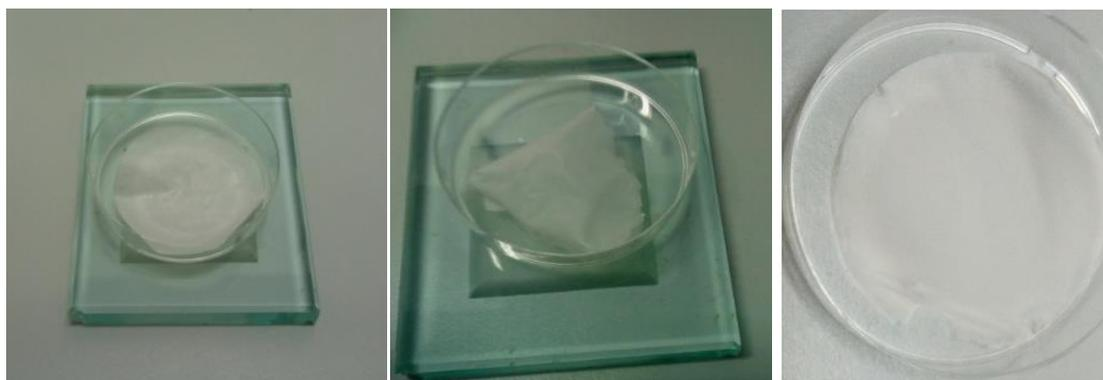
**Figura 3.9:** a) Film ottenuto per filtrazione con un filtro in acetato di cellulosa (sinistra), b) Film ottenuto per filtrazione con un filtro di nylon (centro), c) Film ottenuto per filtrazione con un filtro in PVDF (destra)
