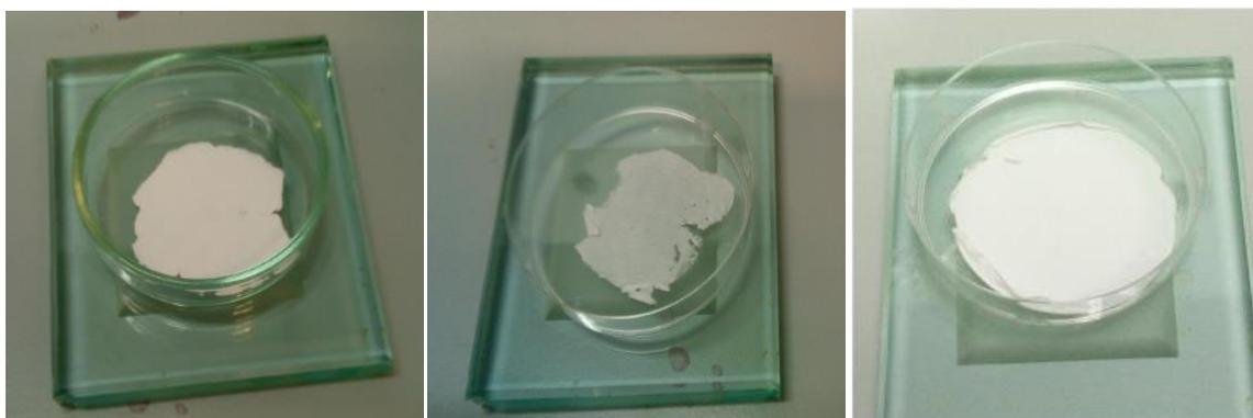
**Figura 3.10:** a) Film ottenuto su Acetato di cellulosa-Etanolo/Acetone (sinistra), b) Film ottenuto su Nylon-Acetone (centro), c) Film ottenuto su PVDF-Acetone (destra)
