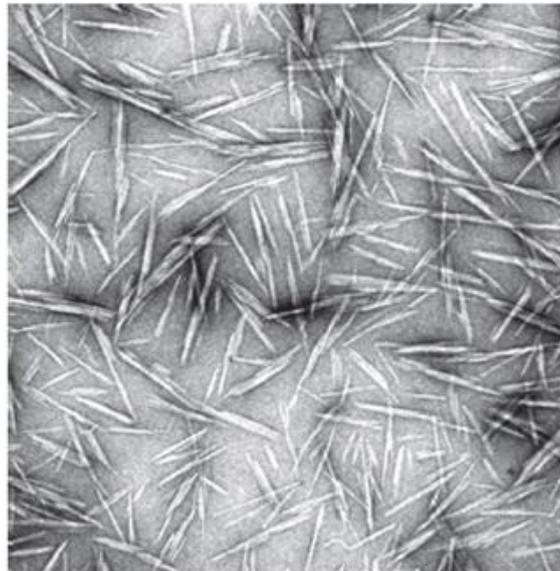
**Figura 1.4:** Micrografia elettronica a trasmissione di nanocristalli di cellulosa [26]
