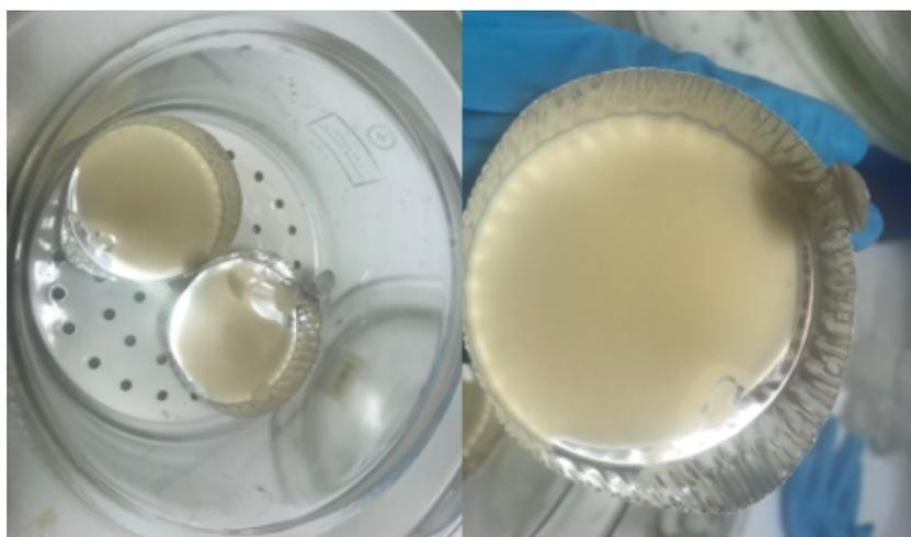
**Figura 12:** Reticolazione termica del prodotto di degradazione PET 1:10 EG
