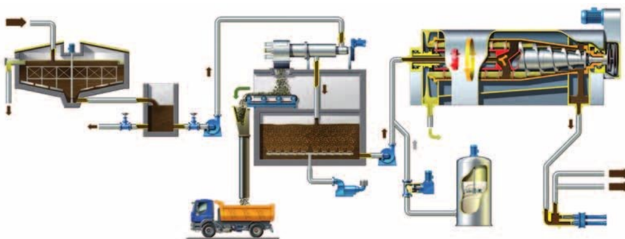
Disidratazione con centrifuga, schema.(Fig.2.7)
