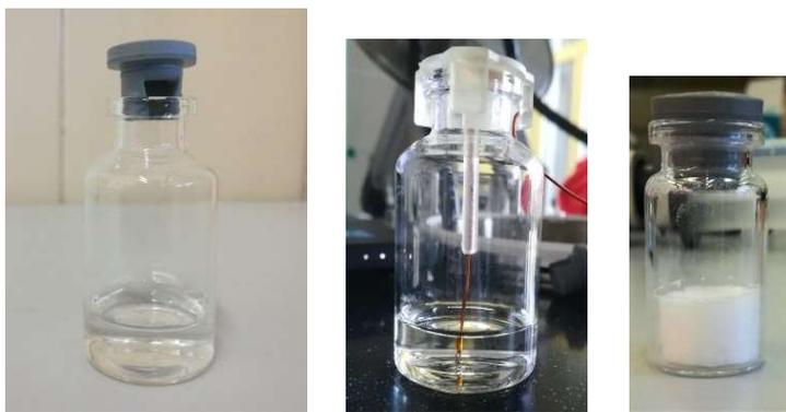
**Figura 2.7** A sinistra: flacone 20R con soluzione acquosa e stopper; al centro: flacone 20R con soluzione acquosa e termocoppia; a destra: flacone 6R con prodotto liofilizzato.
