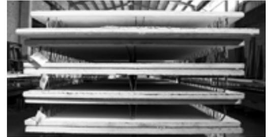
Fig 5\_2. Solaio Predalles depositato in azienda
