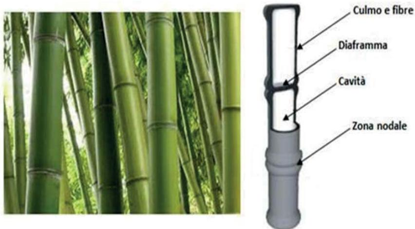
Figura 40 – Aspetto esterno e sezione del culmo di bambù
