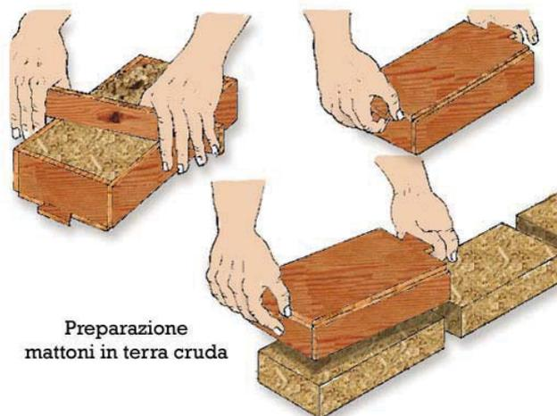
Figura 36 – Produzione di mattoni in terra cruda mediante formatura con cassaforma e pressatura manuale.
