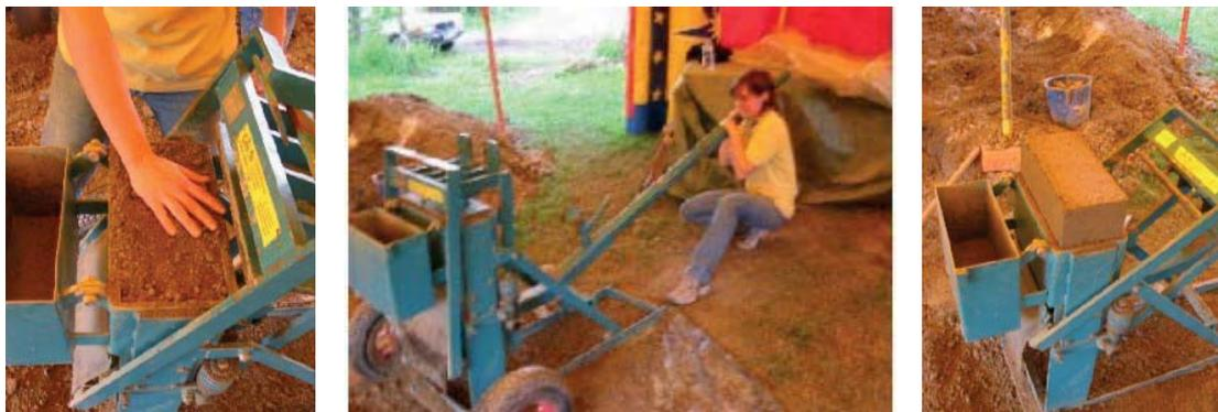
Figura 37 – Produzione di blocchi in terra cruda mediante formatura e pressatura con pressa manuale.
