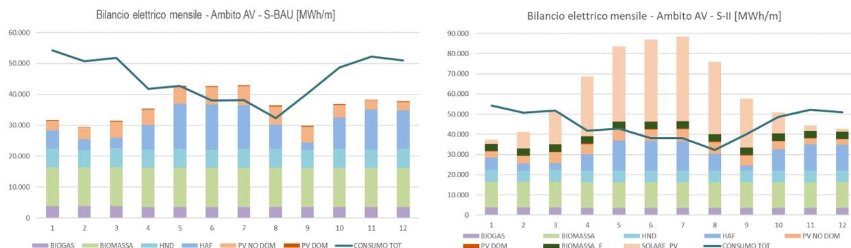
Figure 151-152 – Bilancio elettrico mensile dell'Ambito AV allo stato di fatto (S-BAU, a sinistra) e secondo l'ipotesi d'intervento (S-II a destra).
