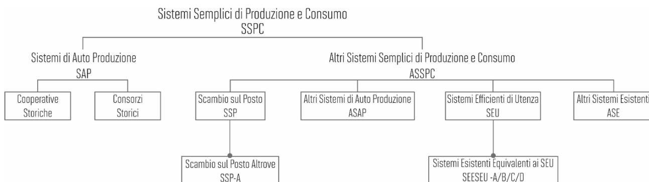
Figura 16 – Schematizzazione dei sistemi semplici di produzione e consumo (SSPC). Elaborazione personale.
