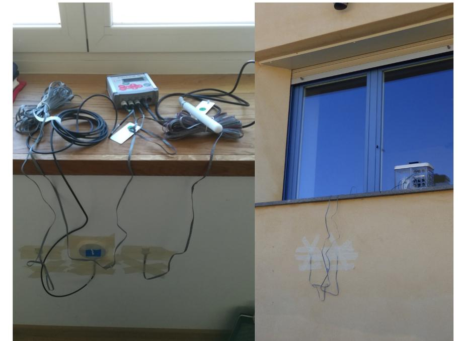
Fig. 119 Sonde applicate sul fronte interno della parete Nord-Est.
