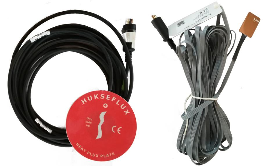
Fig. 97 Il termoflussimetro (immagine a sinistra).
