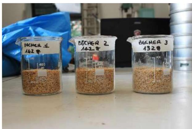
**Fig. 33:** Becher in vetro usati per la misurazione della densità della lolla di riso intera.
