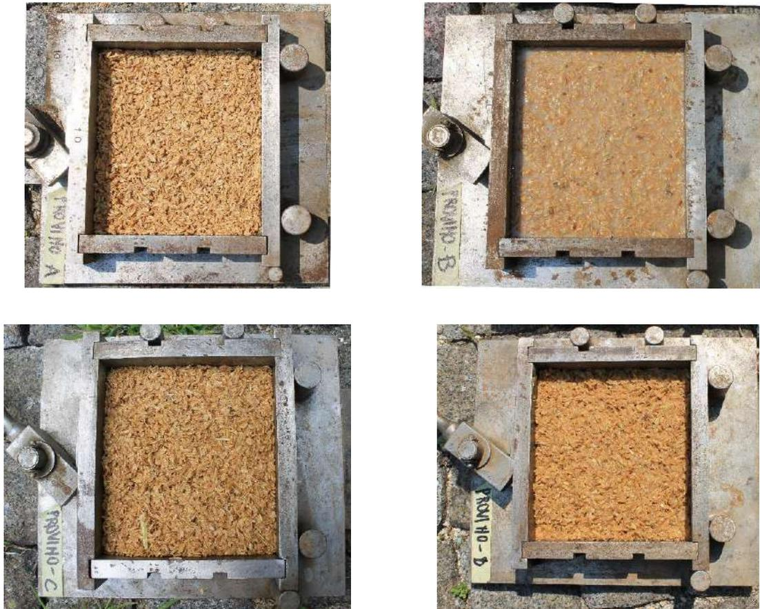
**Fig. 37:** Provini realizzati con lolla intera e amido artigianale. Provino A (70% lolla, 30% amido e magnesite), provino B (50% lolla, 50% amido e magnesite), provino C e D (60% lolla, 40% amido e magnesite).
