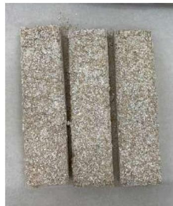
**Fig. 46:** I tre provini realizzati con l'amido di riso, mantenendo la proporzione 1:3 di colla e aggregato.
