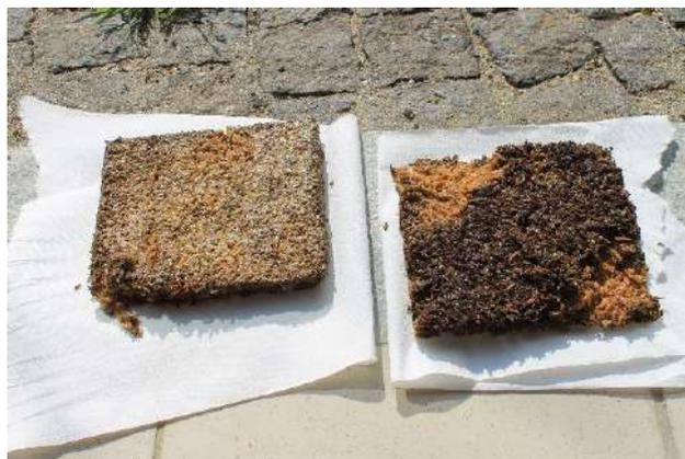
**Fig. 38:** Due provini dopo essere stati scasserati. A sinistra si può notare la muffa dell'amido, mentre a destra la lolla è solo annerita.
