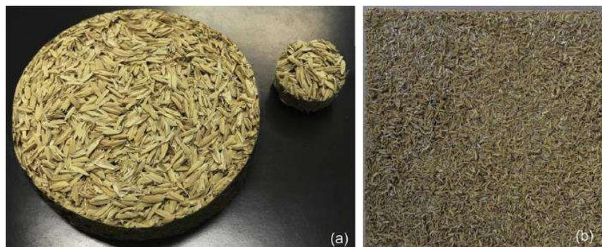
**Fig. 25:** Campioni di lolla di riso e colla poliuretanicata realizzati per le prove acustiche (sinistra) e termiche (destra).
