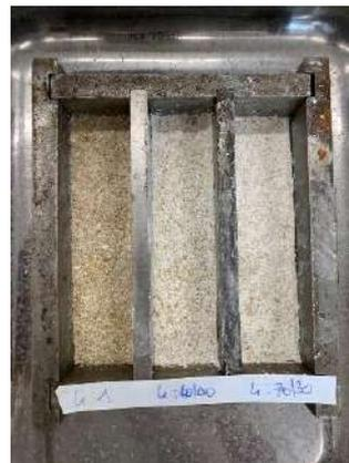
**Fig. 44 e 45:** I sei provini con la colla di amido nelle proporzioni di 1:3 (sinistra) e 1:4 (destra).
