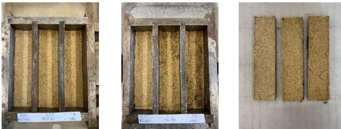
**Fig. 47 e 48:** Provini realizzati con lolla, magnesite e colla in proporzioni 1,5:3 (sinistra) e 2:3 (destra).
