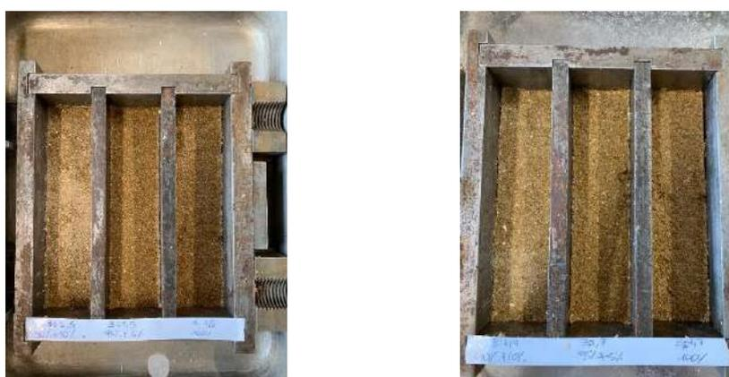
**Fig. 49 e 50:** Provini realizzati con lolla, magnesite e amido in proporzione 1,5:3 (sinistra) e provini realizzati lolla, magnesite e colla in proporzione 1,7:3 (destra).
