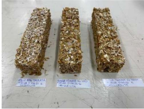
**Fig. 39:** Provini realizzati con lolla non tratta (sinistra), lolla lavata in acqua (centro) e lolla immersa in soluzione di NaOH (destra).
