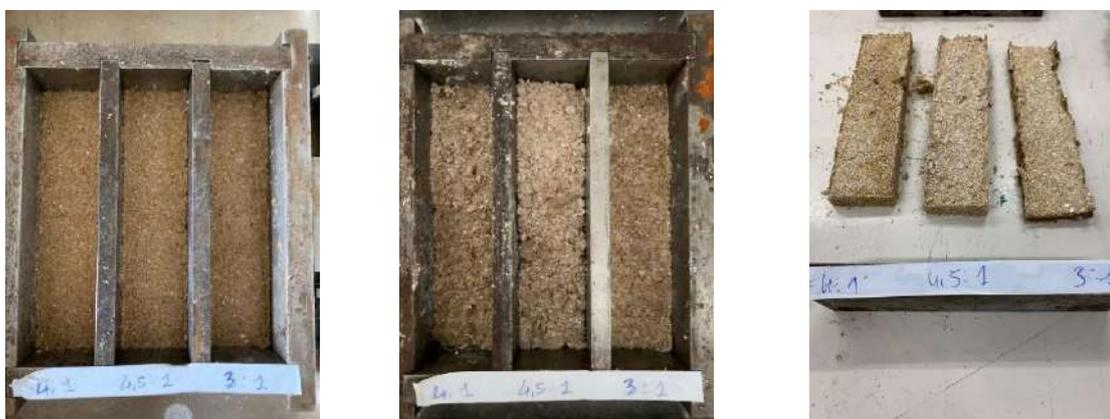
**Fig. 43:** I provini realizzati con colla di amido (sinistra) e con l'amido in polvere (centro). A destra i provini dopo essere stati scasserati.
