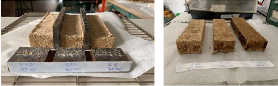
Fig. 51 e 52: Gli ultimi provini realizzati con il mix design finale e lo spessore di 4 cm.
