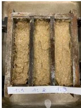
**Fig. 42:** Provini con alta percentuale di colla. 50% aggregato, 50% colla (sinistra); 33% aggregato, 66% colla (centro); 25% aggregato, 75% colla (destra).
