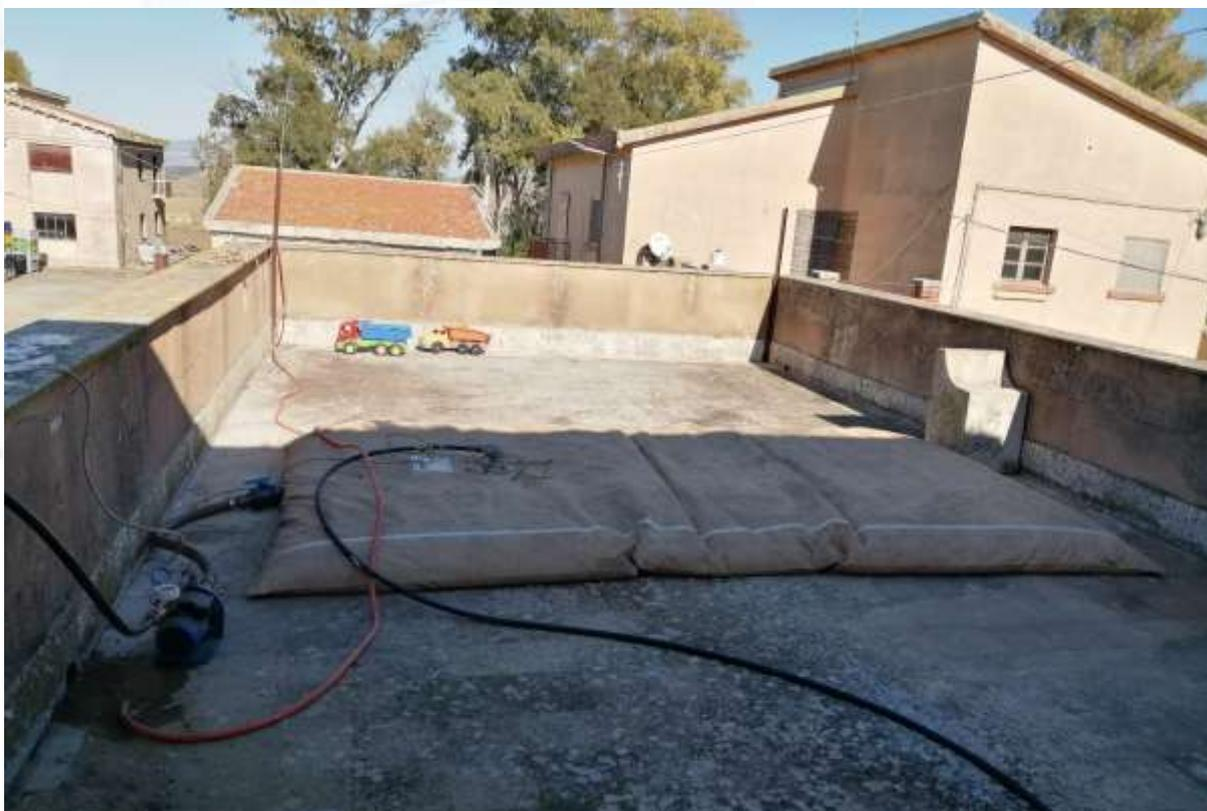
Serbatoio vuoto utilizzato per le prove di carico (prova in edificio tabacchi)
