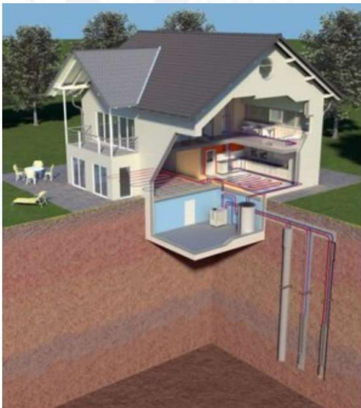
Si caratterizza di **sonde geotermiche profonde** che vengono poste nel sottosuolo degli edifici che ne fruiranno tramite carotatrici al fine di scambiare calore con il sottosuolo in modo naturale e continuo.
