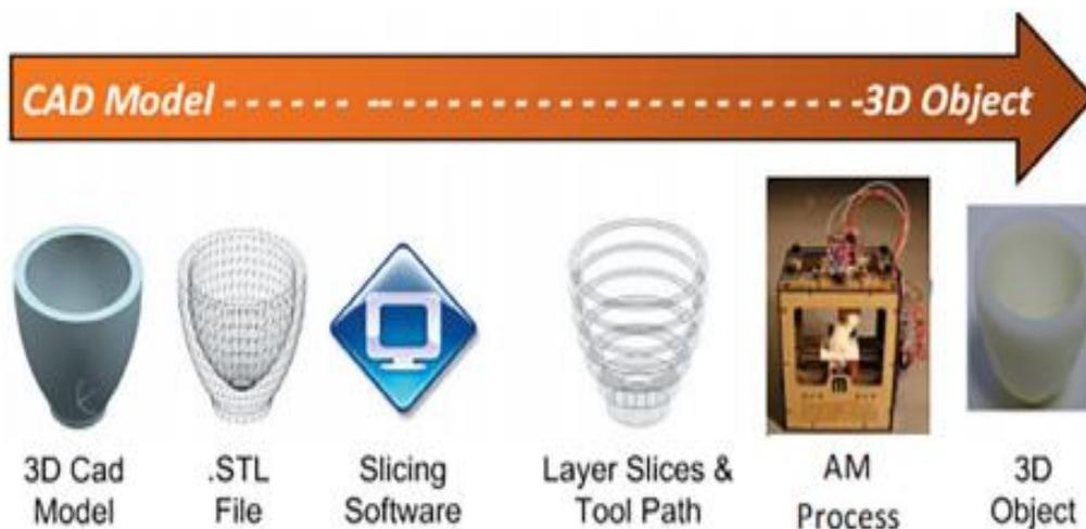
**Figura 2:** Il processo di Additive Manufacturing [2]
