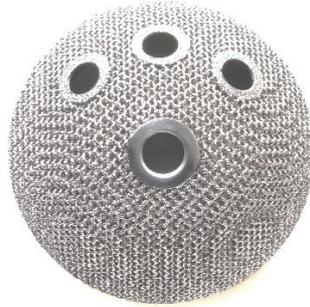
*Figura 17 Protesi per l'anca realizzata da EOS in Ti6Al4V [11]*
