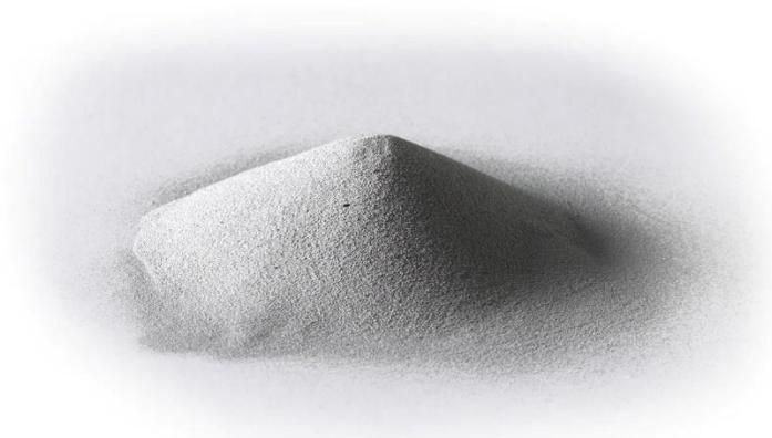
Figura 34 Esempio di polvere metallica Ti6Al4V [16]
