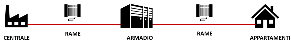
Immagine 1. Struttura ADSL
