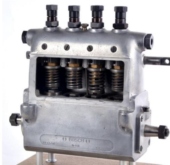
*Figura 1.1.4: pompa di iniezione diesel per autocarri del 1927<sup>[1]</sup>*
