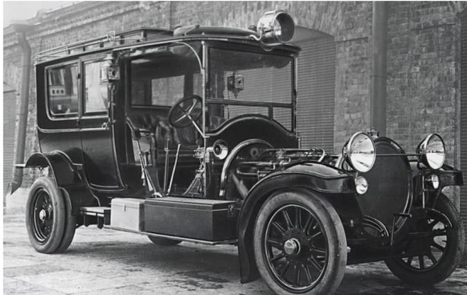
*Figura 1.1.2: Delaunay-Belleville dotata di sistema di illuminazione, sistema di accensione e motorino di avviamento elettrico Bosch<sup>[1]</sup>*
