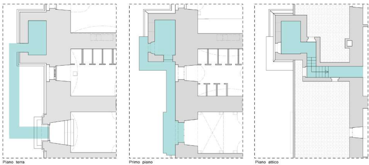
Figura 59. Probabile modalità di accesso alla torre delle latrine ai diversi piani.
