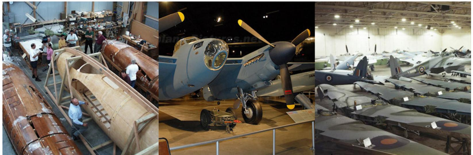
Fig. 44: produzione fusoliera in compensato De Havilland Mosquito e fotografie di un magazzino di produzione
