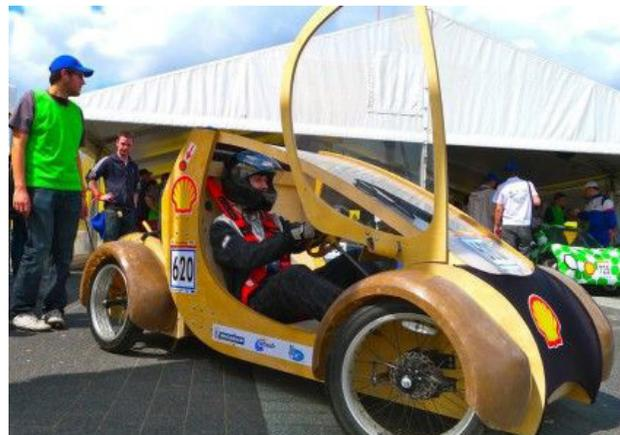
Fig. 72: prototipo in compensato realizzato dalla Aston University in occasione della Shell Eco Marathon 2012 (a sinistra);
