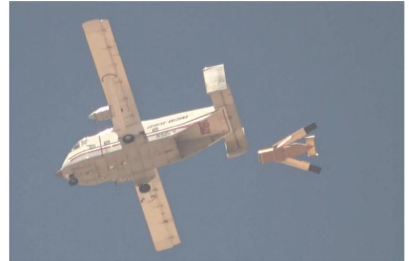
Fig 48: il drone in compensato LG-1K appena sganciato dal suo aereo di trasporto (in alto).
