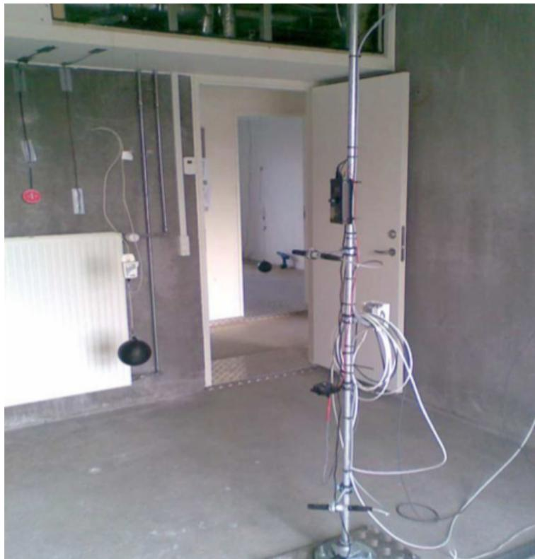
Figura 15. Sensori installati presso il modulo sperimentale dell'Energy Flex House (DEN)
