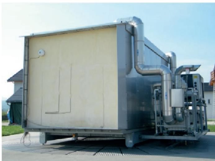
Le pareti esterne non sperimentali delle facility sono altamente isolate, tanto da poter essere considerate adiabatiche, in modo tale da poter eseguire test specifici sui componenti installati nella facciata sperimentale. Proprio quest'ultimi possono essere sostituiti a seconda dei test da effettuare e delle tecnologie da analizzare. Inoltre, le facility sono dotate di ancoraggi per l'installazione di sistemi di schermatura solare interni o esterni (sia automatici che manuali).
