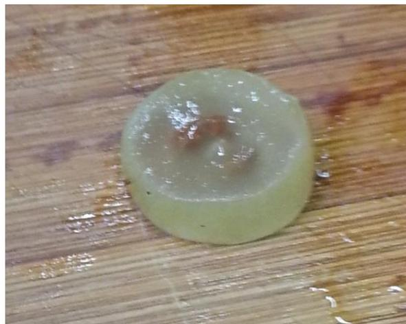
Figura 13: acino privo di pelle dopo la prova di compressione
