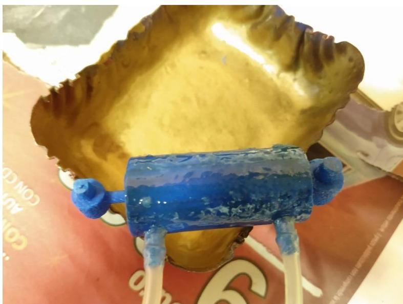
Figura 116 - risultato finale in seguito alle passate di acetone
