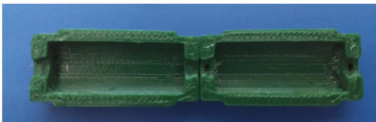
Figura 107 - camicia interna del cilindro in TPU
