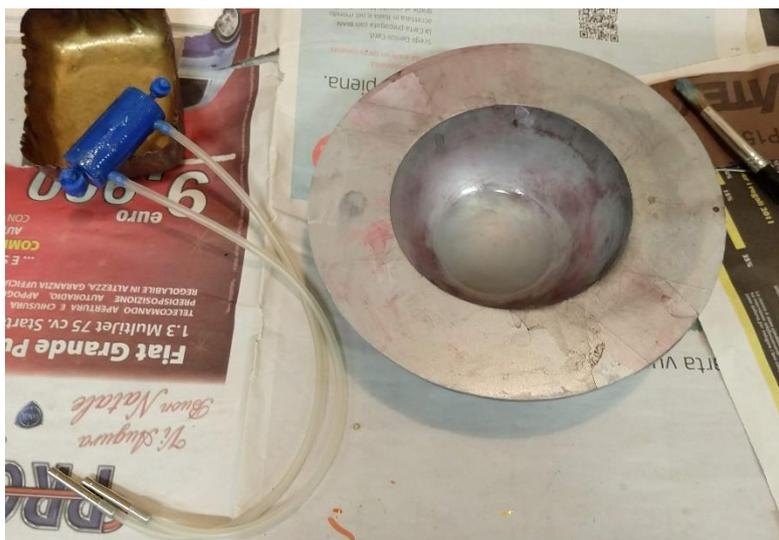
Figura 115 - operazione di fissaggio con passate di acetone
