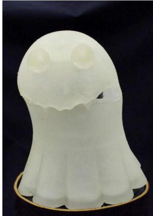
Figura 9 - robot skin additiva realizzata con stampa 3D
