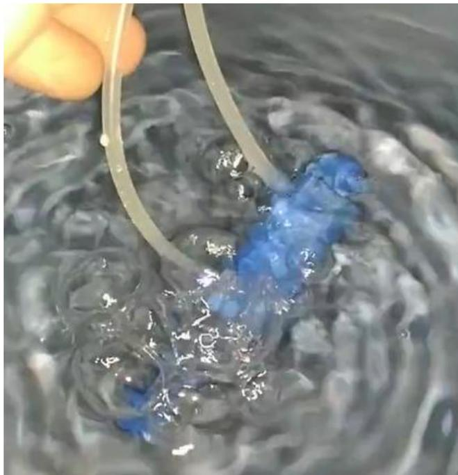
Figura 131 - cilindro immerso in acqua per valutazione qualitativa della produzione di bolle
