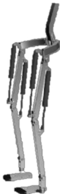
L' esoscheletro raffigurato è una struttura attiva utilizzata in ambito medico per la deambulazione. Il sistema pensato da N. Koceska, presenta 10 gradi di libertà e permette al paziente tutti i movimenti necessari per recuperare l' andatura corretta. Come mostra la figura, per poter controllare i movimenti delle articolazioni dell' anca e del ginocchio sono presenti quattro attuatori pneumatici con stelo a doppio effetto, comandati da due valvole proporzionali.
