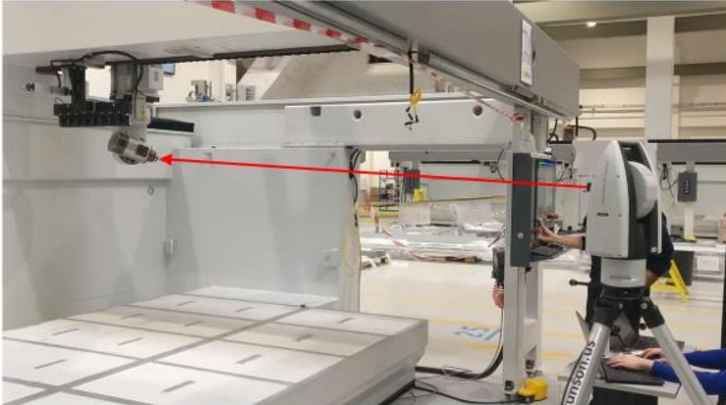
*Figura 75 - Direzione del fascio laser emesso*
