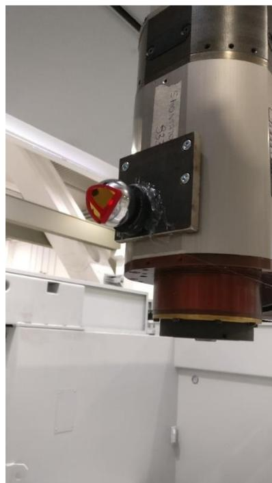
Figura 74 - Laser Tracker Leica, sfera ricevitrice
