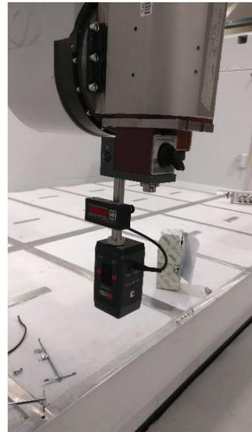
*Figura 42 - Laser Hamar, emettitore e ricevitore*
