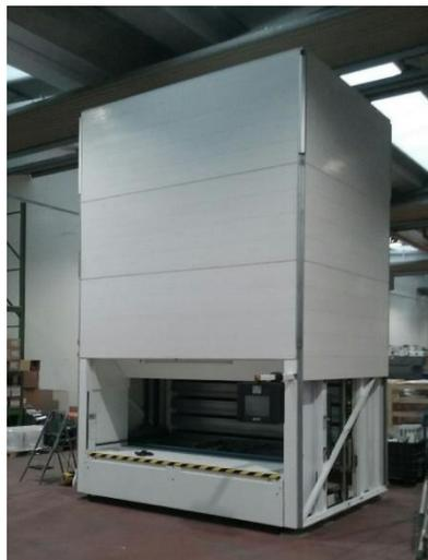
65 - Esempio di magazzino automatico con carosello verticale
