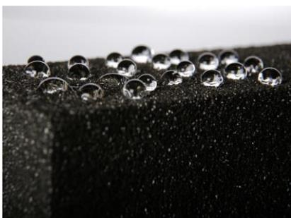
Figura 140. Foamglas® è impermeabile all'acqua e al vapore, la sua resistenza alla pressione è comprovata anche per lunghi periodi.
