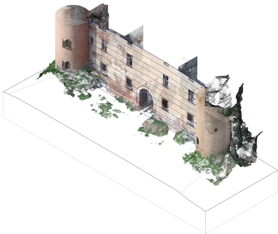
^ 9. Nuvola fotogrammetrica inserita nel modello Revit (fuori scala) Le linee in blu sono state generate sezionando la nuvola con vari piani ad altezze diverse e disegnandole seguendo il profilo.
