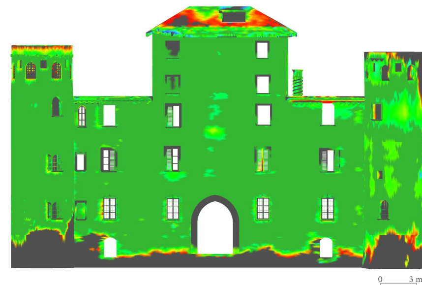
▲ 35. Prospetto Sud del modello fotogrammetrico (prima ispezione) Per i colori far riferimento al grafico a destra della pagina precedente.
