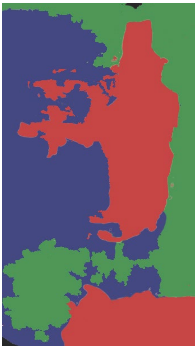
^ 13. Stralcio del prospetto Ovest con tre tipologie di degrado differenti Verde: Alterazione Cromatica; Blu: Disgregazione; Rosso:Distacco.
