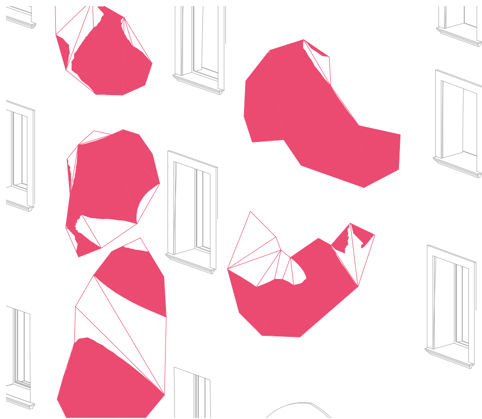
▲ 5. Applicazione dei componenti sul prospetto sud (fuori scala) I vertici ed il perimetro esterno seguono la superficie, ma l'area interna è molto imprecisa
