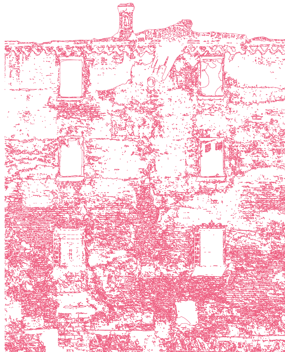
^ 10. Polyline ottenute da Rooster Per ogni variazione di colore si viene a creare una Polyline ad essa corrispondente
