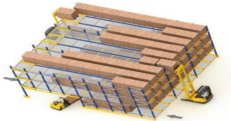
Figura 3.7: Magazzino a gravità con Logica FIFO
