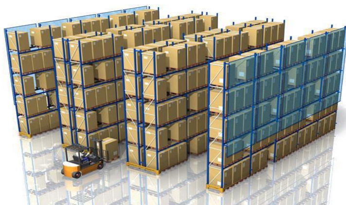
Figura 3.5: Scaffalatura Porta-Pallet a singola profondità
