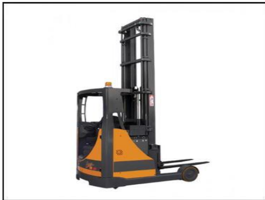
Figura 4.8: Carrello a forche con montanti retrattili
