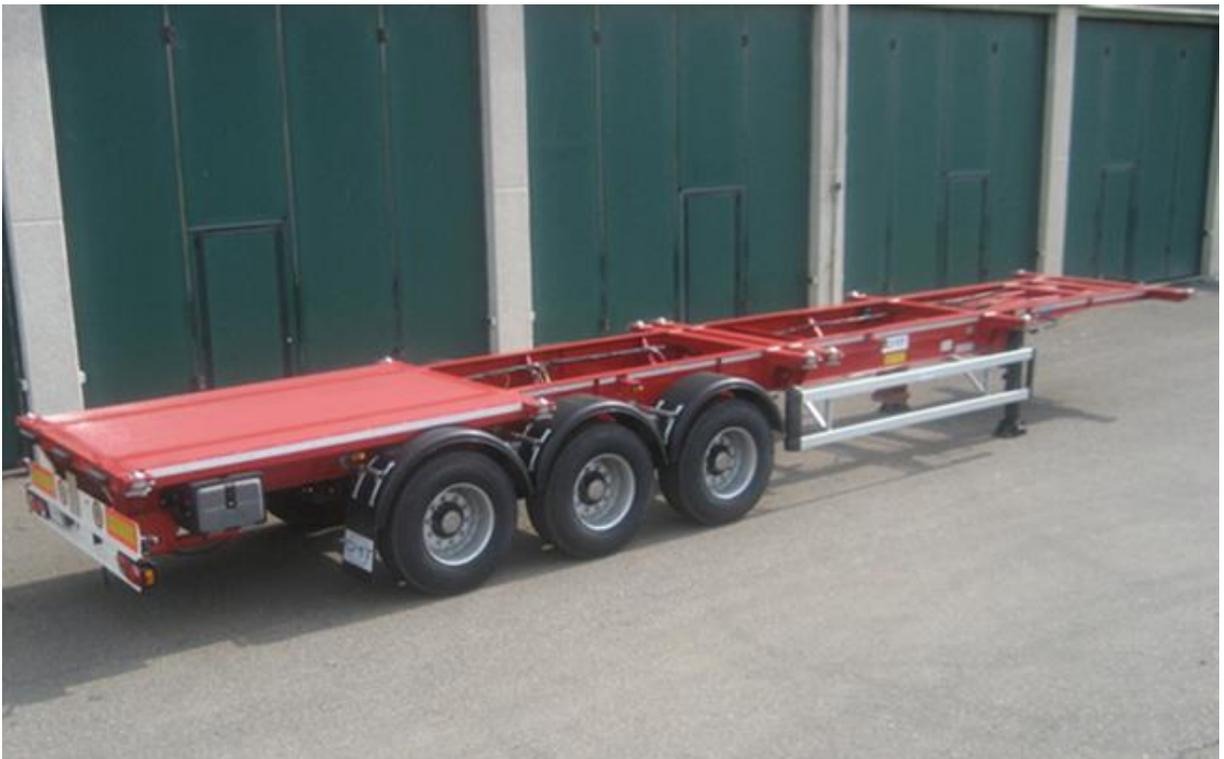
*Figura 7. Esempio di porta container estensibile*
