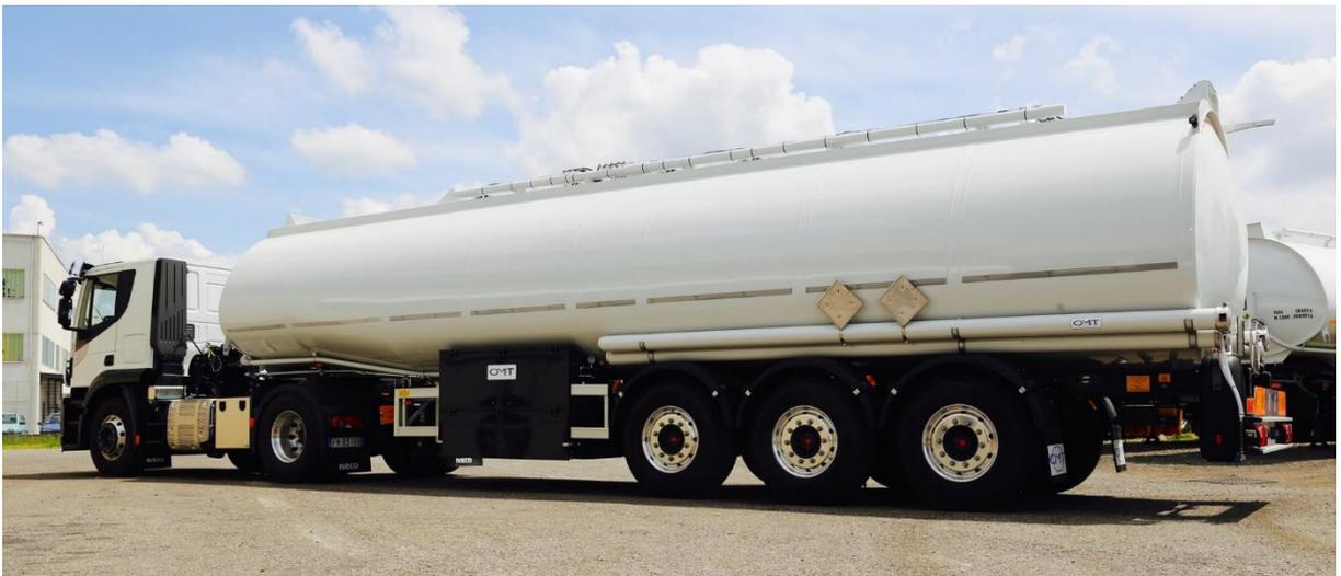
*Figura 3. Esempio di autoarticolato (o bilico): unione di trattore stradale e semirimorchio*
