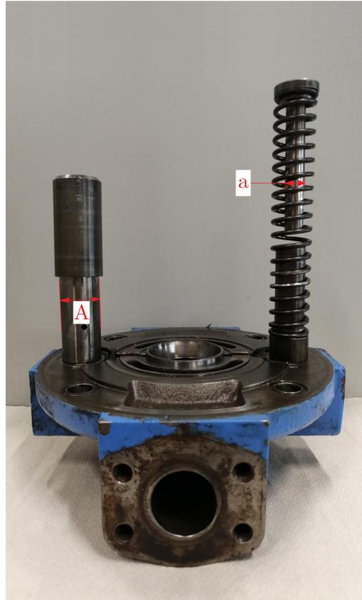
Figura 2.17: Comando di variazione della cilindrata - superfici di influenza
