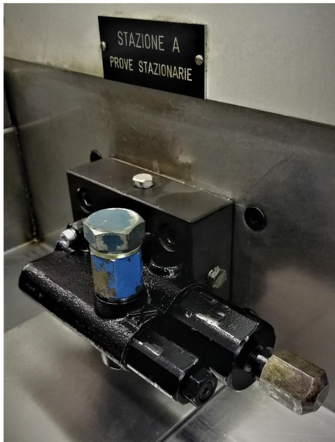
Figura 4.10: Montaggio al banco della valvola
