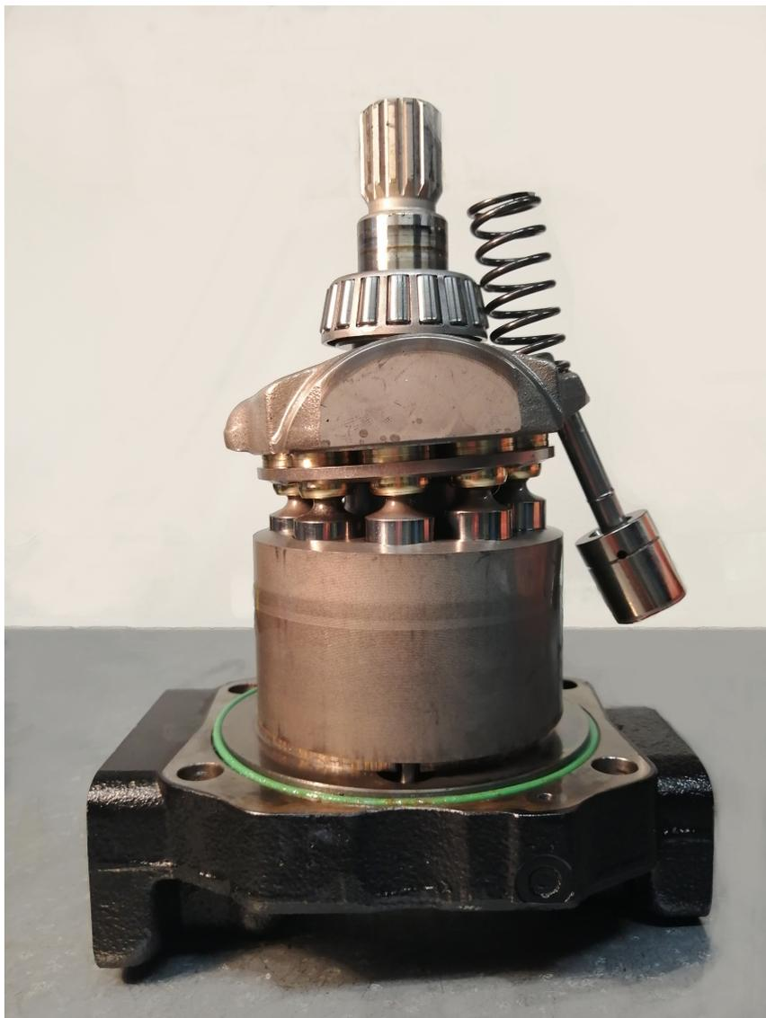
Figura 4.6: Componenti della pompa Rexroth serie 3.1
