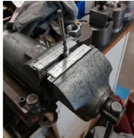
Figura 93: Lavorazioni per il foro M8
