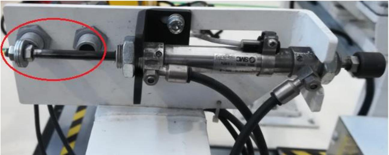
Figura 33: Sensori di inizio e fine corsa visti da davanti
