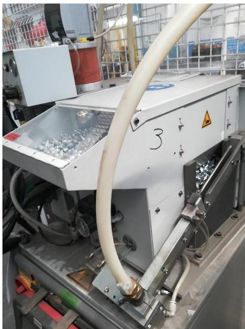
Figura 15: Perni stanziati nella centralina e tubo di plastica mediante il quale vengono inviati alla saldatrice
