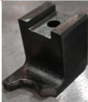
Figura 121: Rottura fragile a seguito dell'infragilimento da tempra
