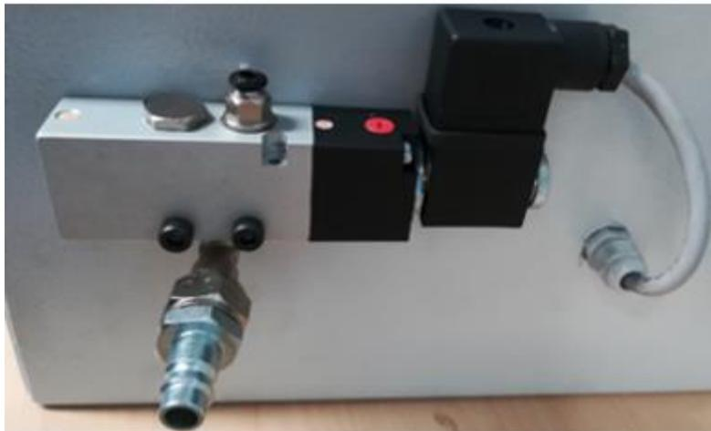
Figura 128: Valvola pneumatica monostabile con commutazione elettrica
