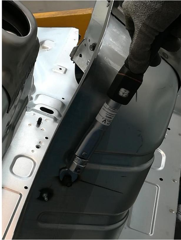
Figura 28: Prova di collaudo dei perni M8
