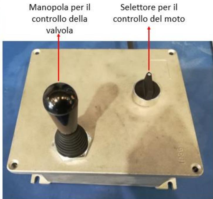
Figura 113: Primo Pannello di controllo
