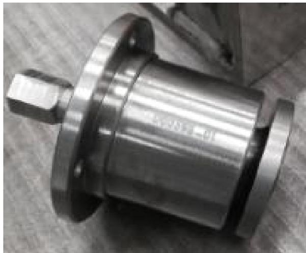
Figura 66: Gruppo Supporto cuscinetti realizzato e montato
