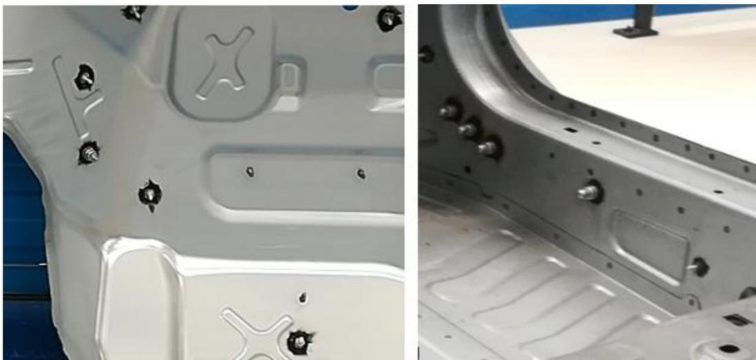
Figura 7: Perna realmente saldati sul cruscotto o sul longherone
