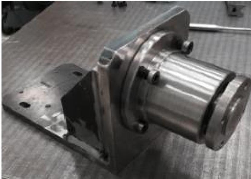
*Figura 69: Struttura elettrosaldata e Sostegno cuscinetti*
