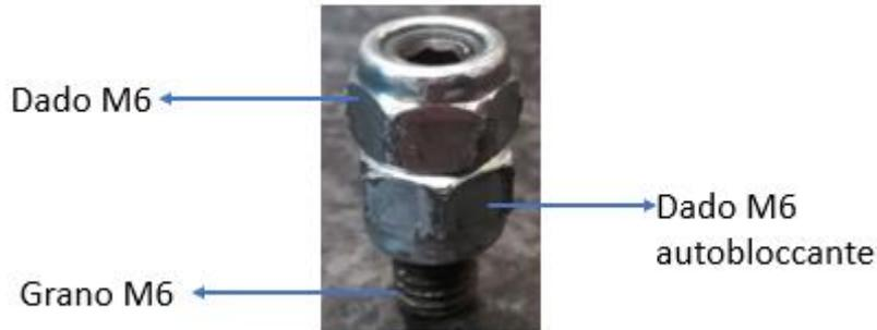
Figura 114: Grano con i dadi esagonali M6 per la prova di taratura
