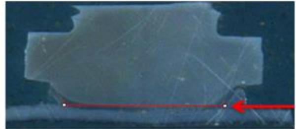
Figura 17: Macrografia saldatura del perno sulla lamiera
