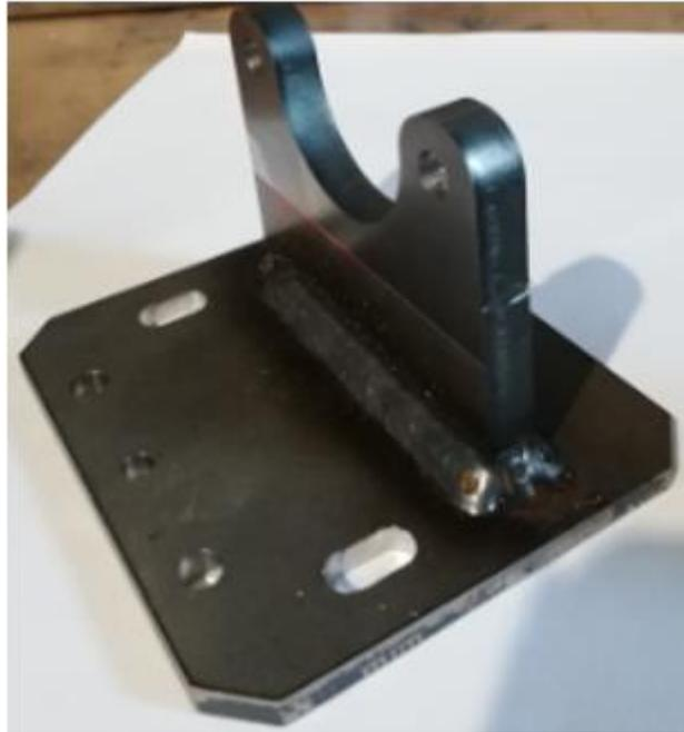
Figura 105: Supporto motore realizzato
