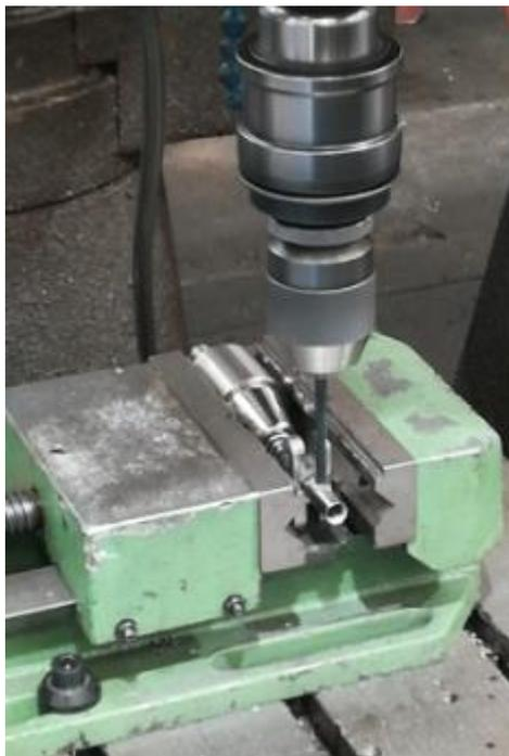
Figura 82: Foratura della Bocca di centraggio al trapano
