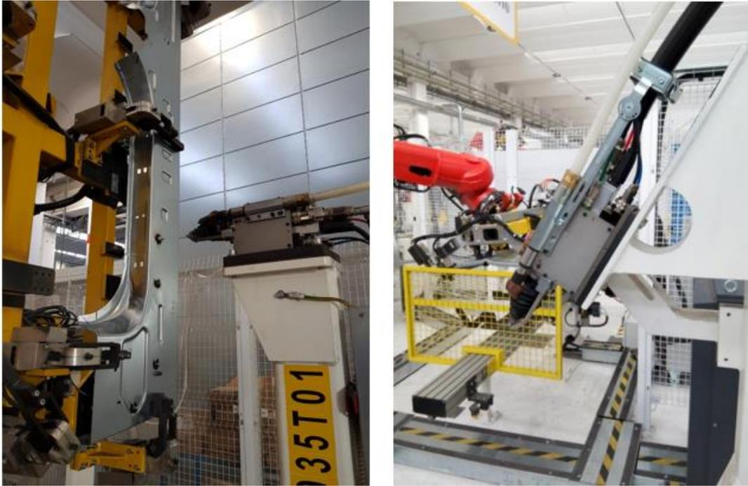
Figura 12: Saldatrice fissa su colonnina o mobile montata sul polso robotico
