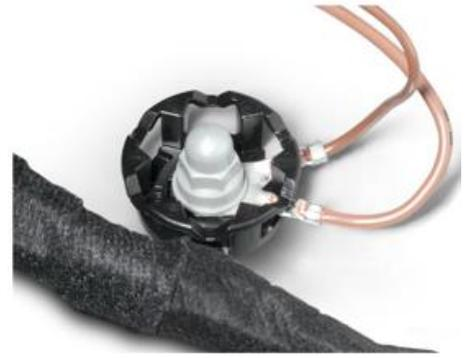
Figura 10: Collegamento di 2 circuiti elettrici allo stesso perno di massa
