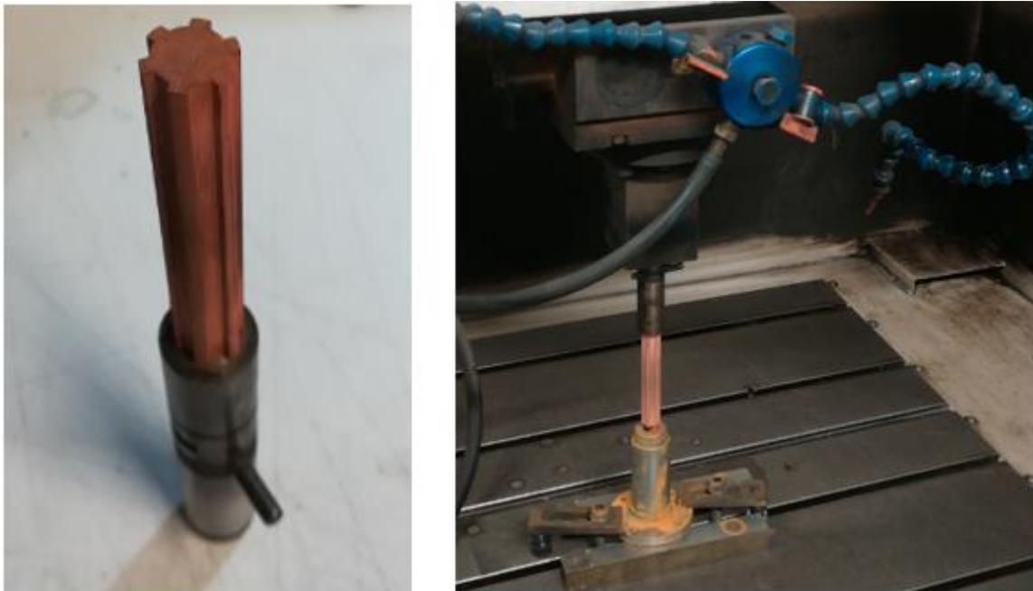
*Figura 109: Elettrodo di rame e foratura per elettroerosione*
