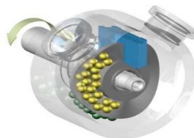
**Figura 1.7** Pompa a rotore sinusoidale
