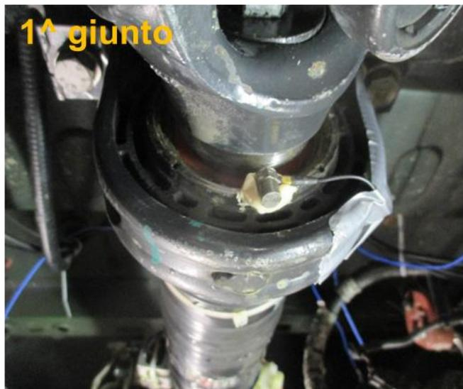
Figura 40: Punto di applicazione dell'accelerometro sul supporto dell'albero di trasmissione
