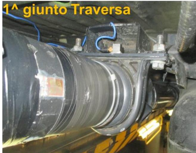
Figura 41: Punto di applicazione dell'accelerometro sulla traversa del supporto dell'albero di trasmissione
