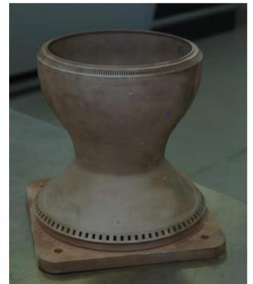
Figure 33) Copper rocket nozzle
