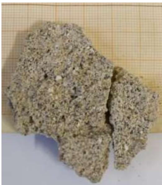
Figura 3. Frammento di intonaco analizzato tramite diffrazione dei raggi X. (1 quadratino = 1 mm)
