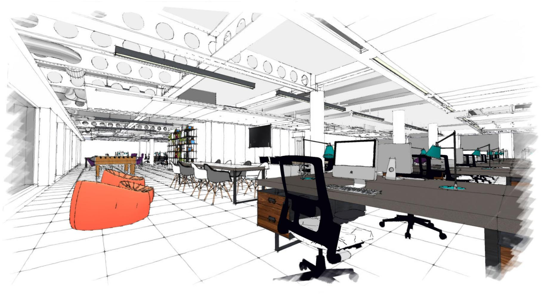
Fig. 91 - Vista del terzo piano, travi alveolari a vista e controsoffitto, ambiente degli uffici.
