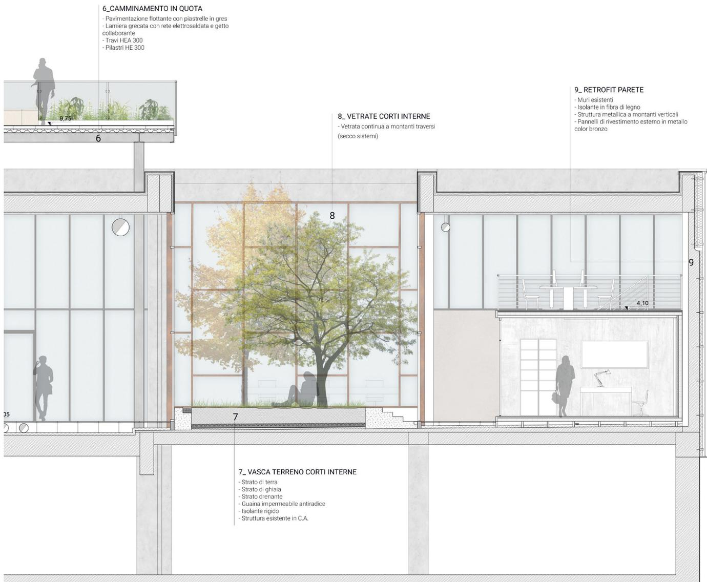
Figura 4. Sezione trasversale del coworking con dettagli tecnologici
