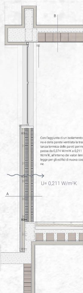
Con l'aggiunta di un isolamento esterno e della parete ventilata la trasmittanza termica delle pareti perimetrali passa da  $0,374 \text{ W/m}^2\text{K}$  a  $0,211 \text{ W/m}^2\text{K}$ , all'interno dei valori limite di legge per gli edifici di nuova costruzione.
