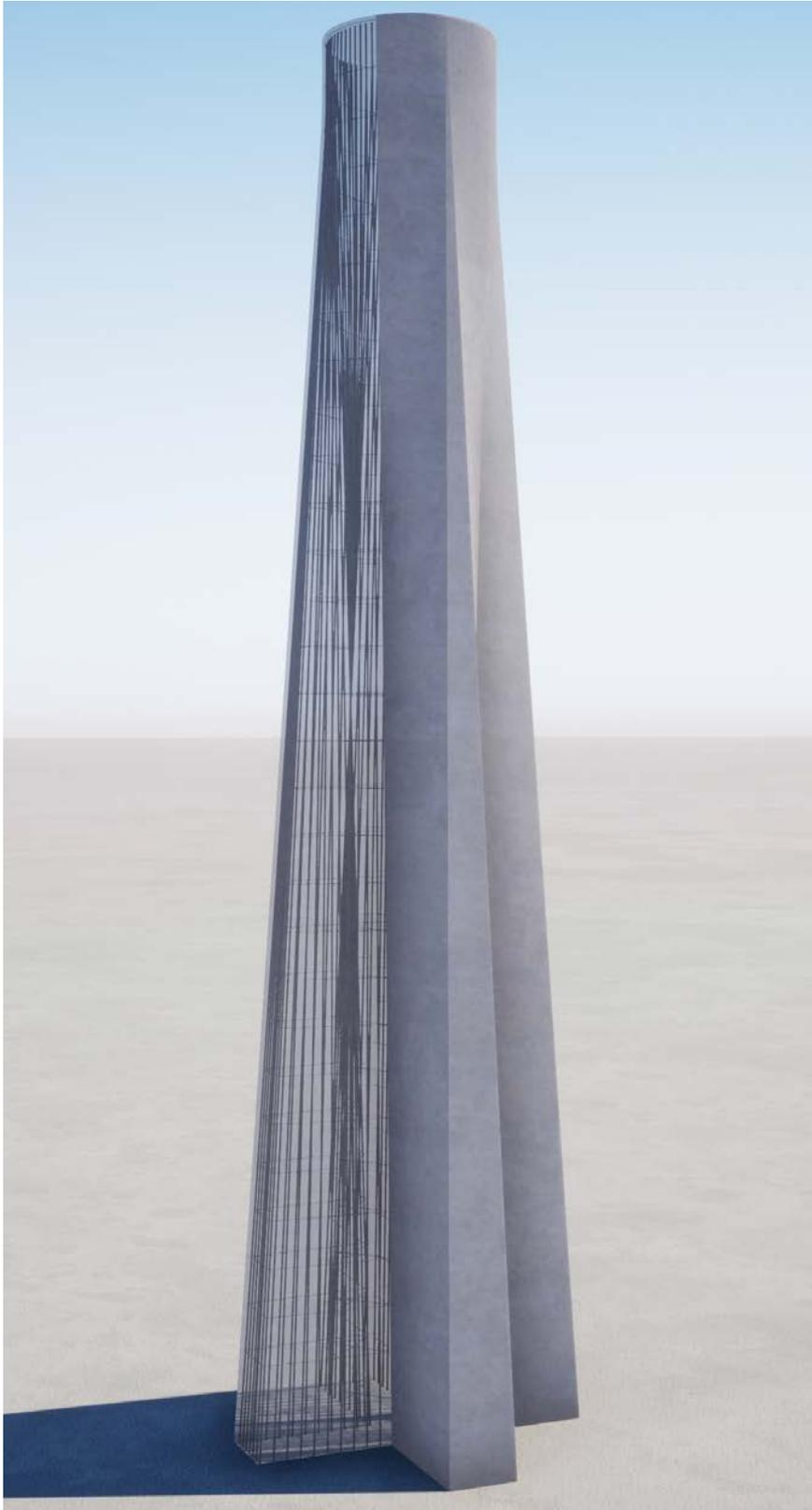
Modellazione 3D armature del pilastro principale.
