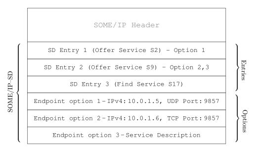
Figura 6.1: Struttura di un messaggio SOME/IP-SD.
