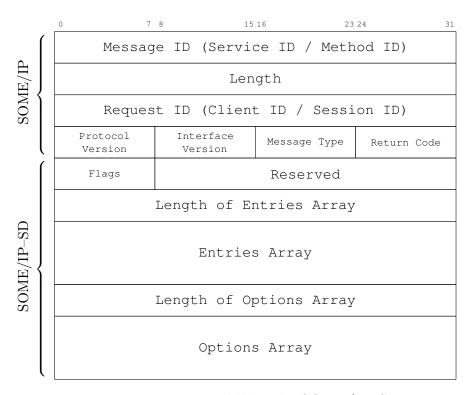
Figura 3.4: Formato dell'header SOME/IP-SD.
