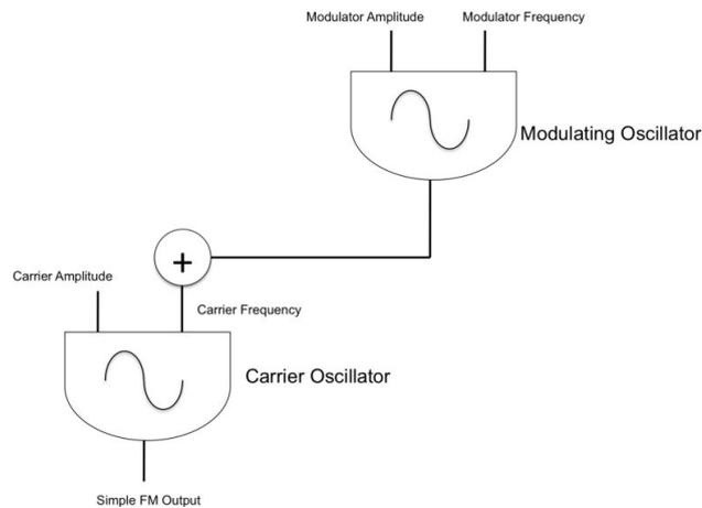
Figure 5.3. Rappresenta due oscillatori in configurazione sintesi FM, in cui l'oscillatore Modulante, modula la frequenza del Carrier.
