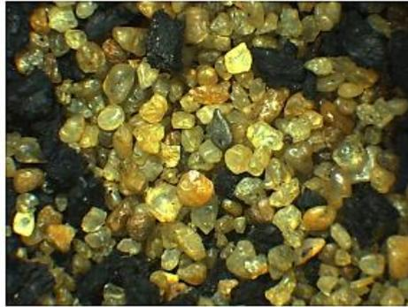
Figura 76. Immagine al microscopio della sabbia utilizzata
