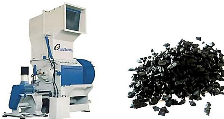
Figura 8. Mulino granulatore e granulato di gomma
