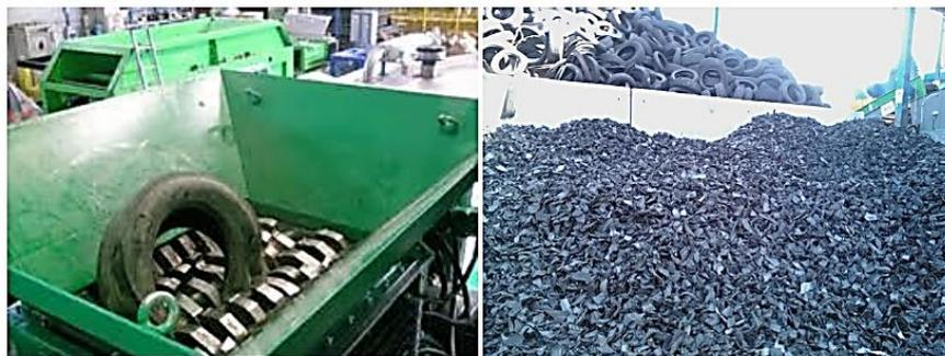
**Figura 7.** Mulino tritratore e ciabattato di pneumatico
