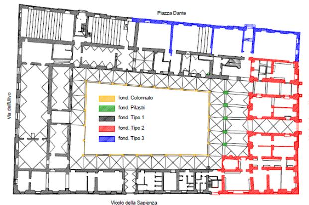
**Figura 31:** Schematizzazione delle fondazioni [21].
