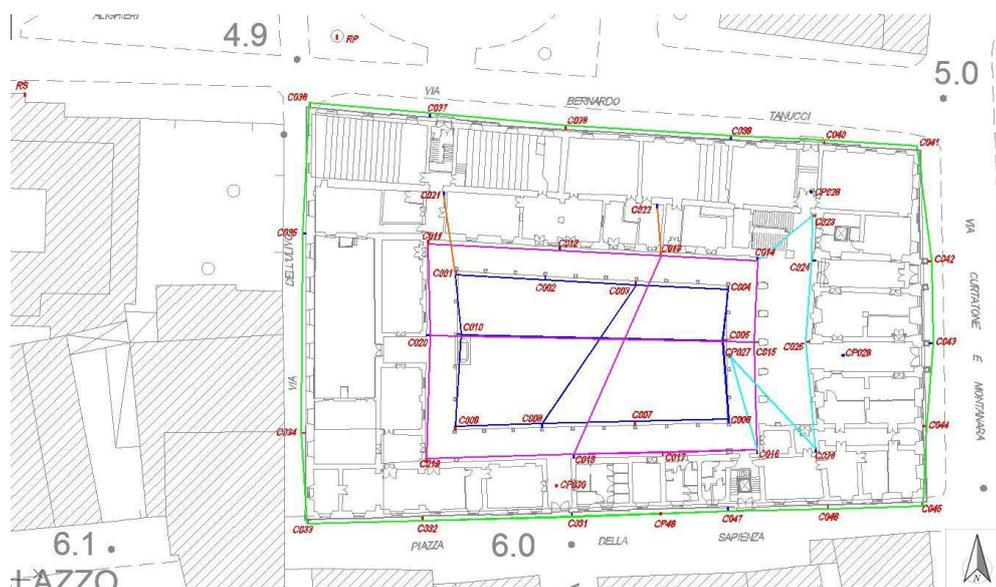
**Figura 30:** Anelli principali della rete di monitoraggio [20].
