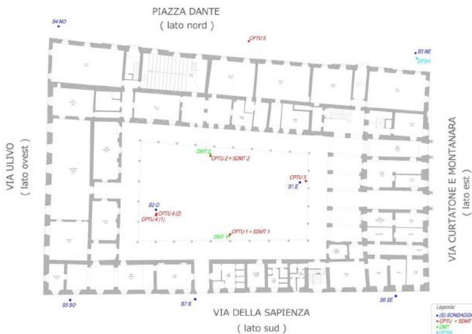
**Figura 25:** Disposizione planimetrica delle indagini geotecniche effettuate nel 2013 [20].
