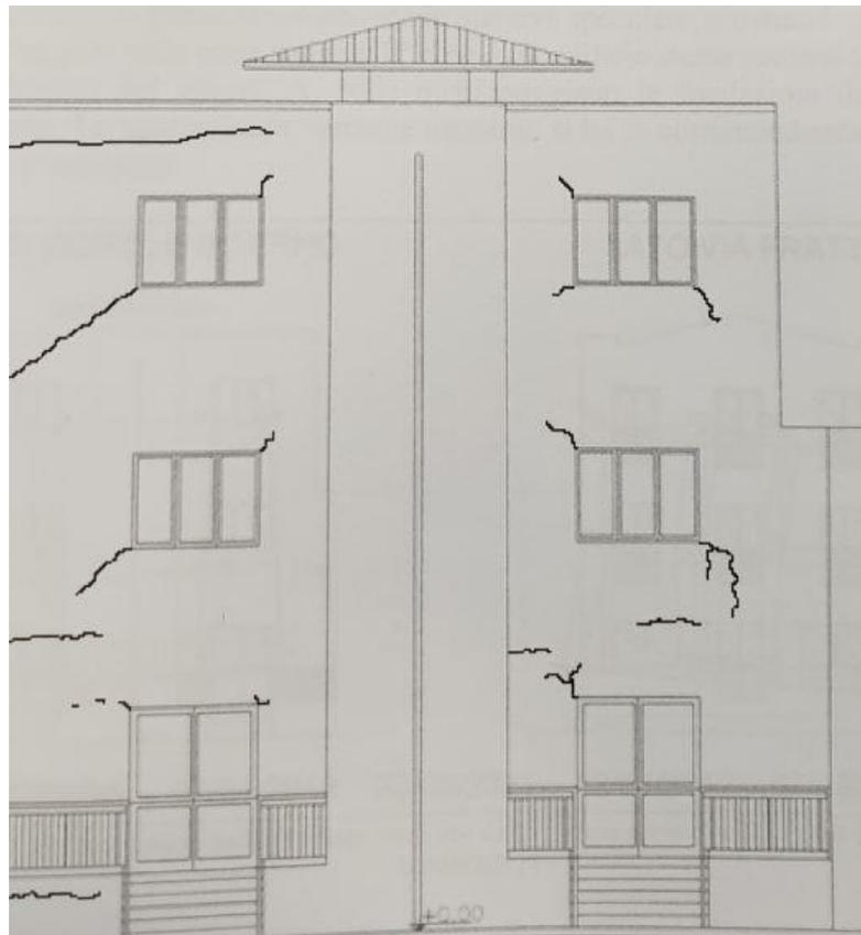
**Figura 57:** Rilievo delle fessure nella facciata lato cortile eseguito in data 30/01/2014.
