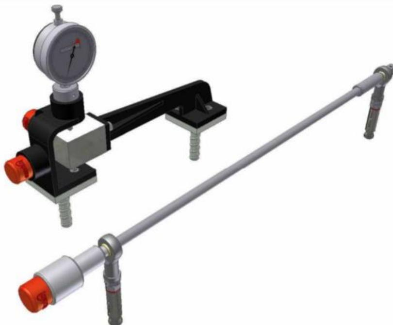
**Figura 3:** Fessurimetro meccanico a quadrante per la misura di movimenti tridimensionali in alto e per misure lineari in basso ([www.sisgeo.com](http://www.sisgeo.com)).
