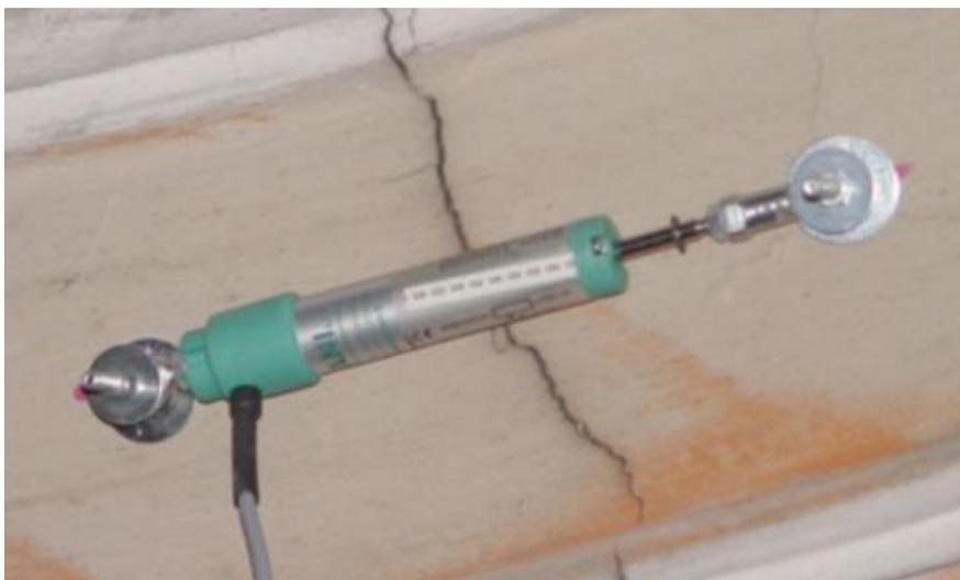
**Figura 4:** Fessurimetro potenziometrico ([www.brescianisrl.it](http://www.brescianisrl.it)).
