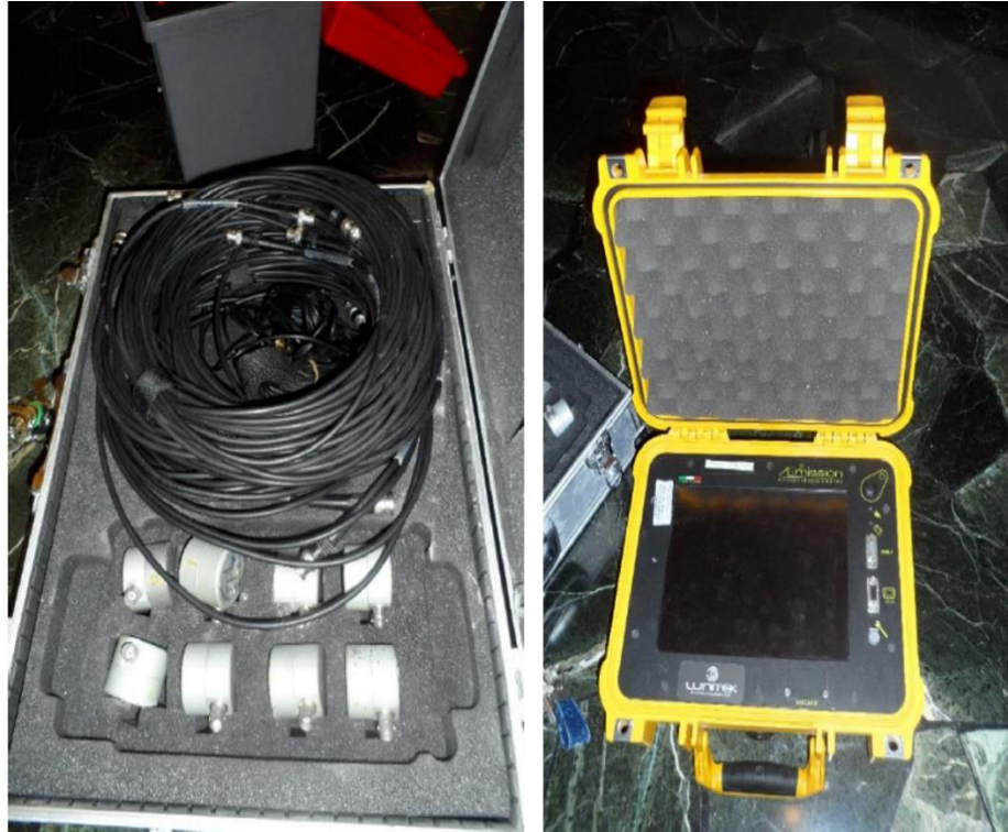
Figura 33. Sistema di acquisizione dati utilizzato per il monitoraggio
