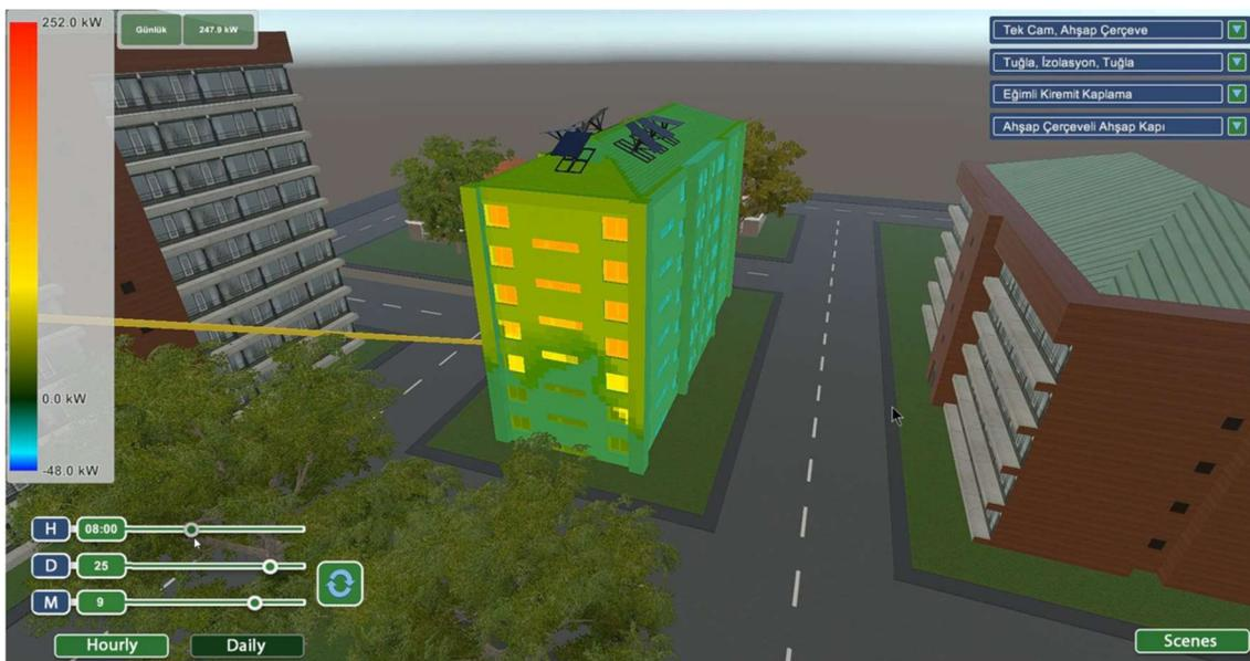
Figura 1.4.4: Stima dell'irradiazione solare degli edifici per una data e un'ora specifiche – Argedor.
