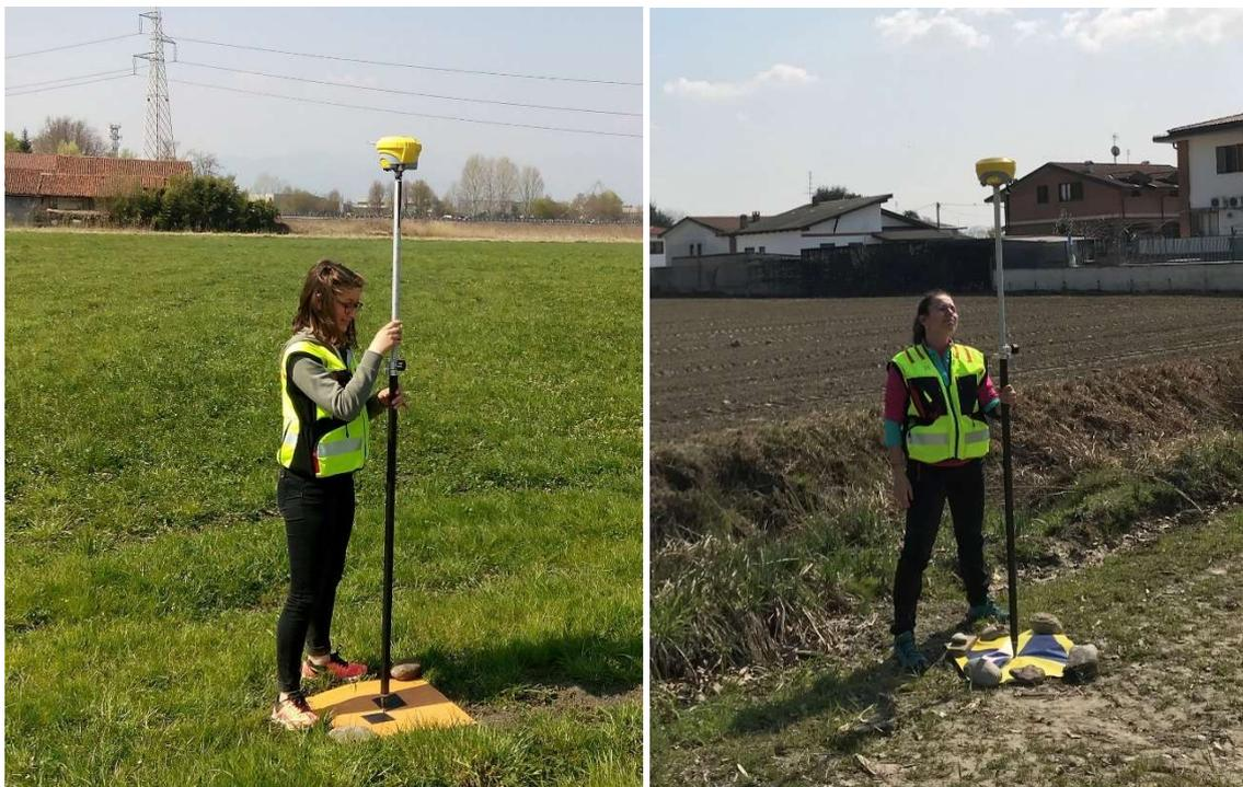
*Figura 3.3.1: Materializzazione GCP: marker in plastica semi-rigida e PVC flessibile.*
