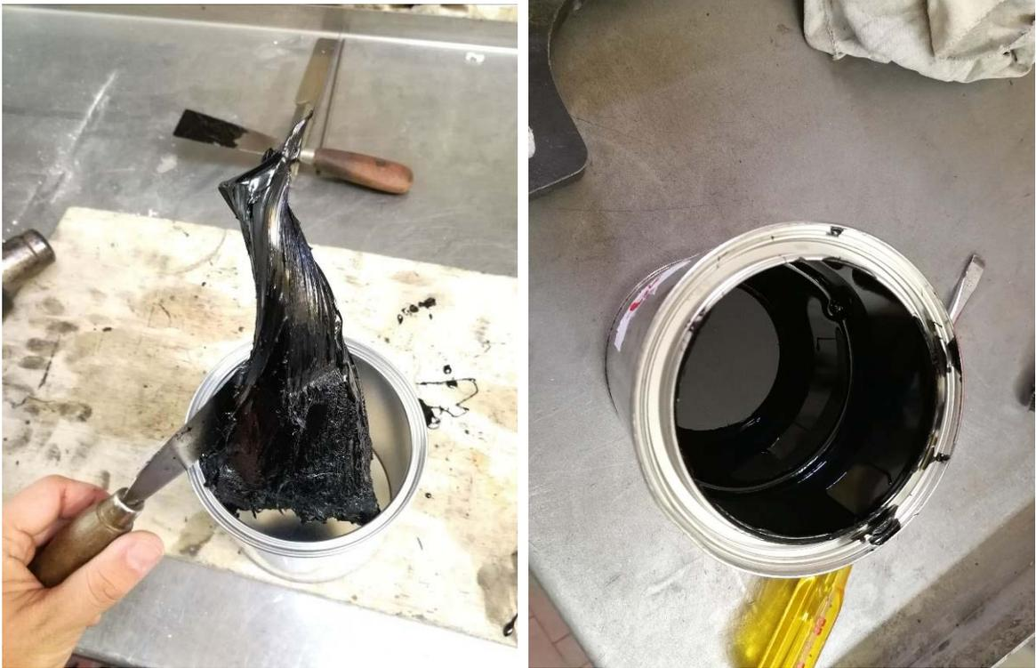
Figura 4.2 Prelievo campione bitume (Sx) e bitume scaldato (Dx)
