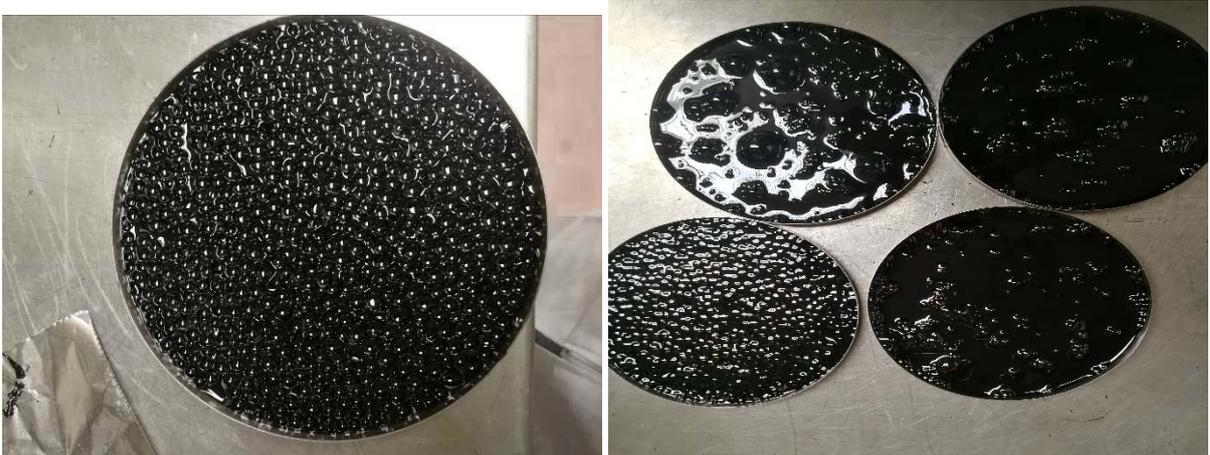
Figura 4.9 Bolle d'aria sulla superficie del campione
