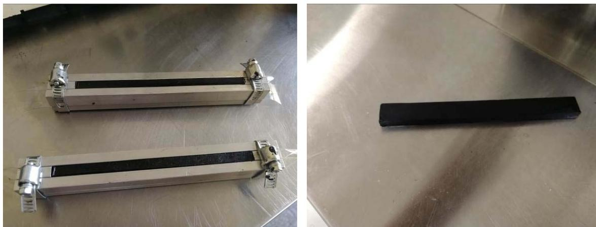
Figura 4.18 a) Cassero in acciaio pieno; b) Travetto di bitume
