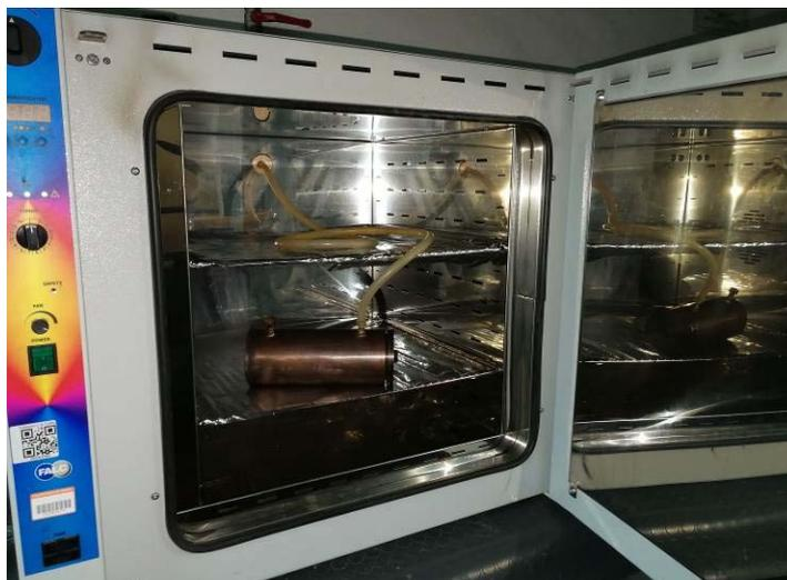
Figura 4.11 Forno e contenitore ermetico
