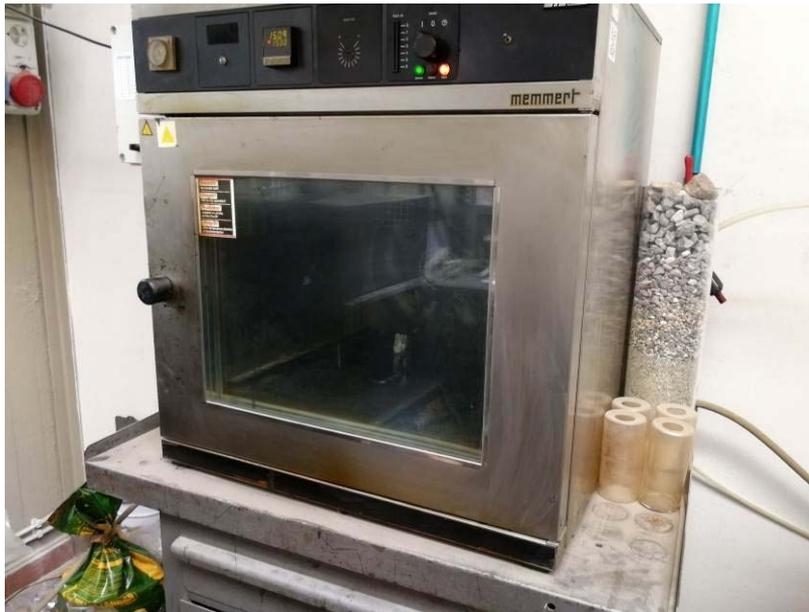
Figura 4.3 Forno per il RTFOT
