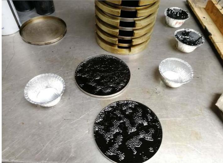
Figura 4.8 Bitume invecchiato al PAV
