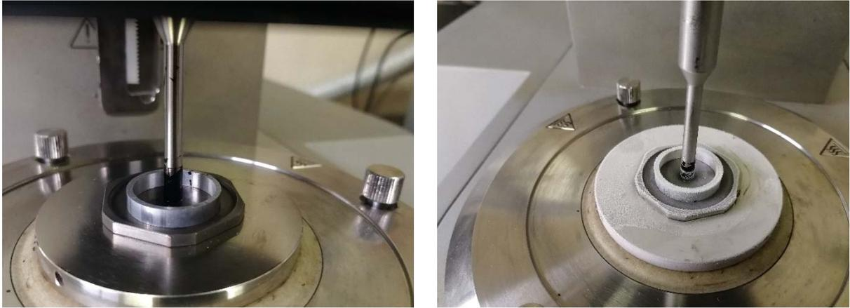
Figura 4.24 Preparazione ed esecuzione della prova con PP04
