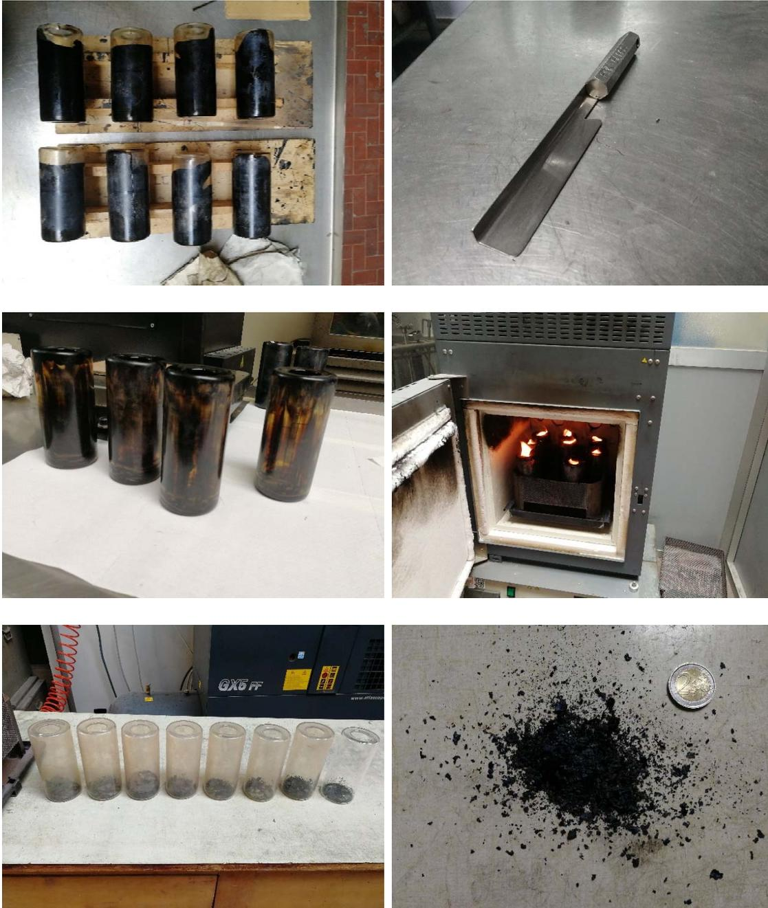
Figura 4.5 da sx a dx, dall'alto al basso: a) bicchieri; b) bicchieri in forno; c) banco di lavoro; d) bilancia; e) bitume a riposo; f) spatola; g) residui di bitume; h) carbolite; i) residui nel bicchiere; j) residuo.
