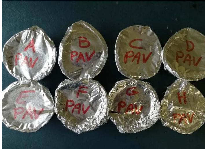
Figura 4.10 Stoccaggio degli otto bitumi
