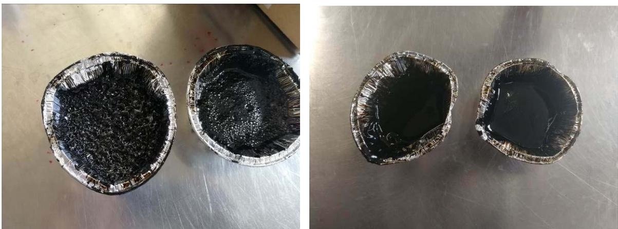
Figura 4.13 Bitume prima (sx) e dopo il degassing (dx)
