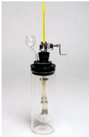
Figura 2.32 Strumentazione per la prova Fraas
