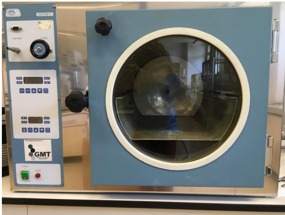
Figura 1.4. Forno per invecchiamento termico con campioni all'interno
