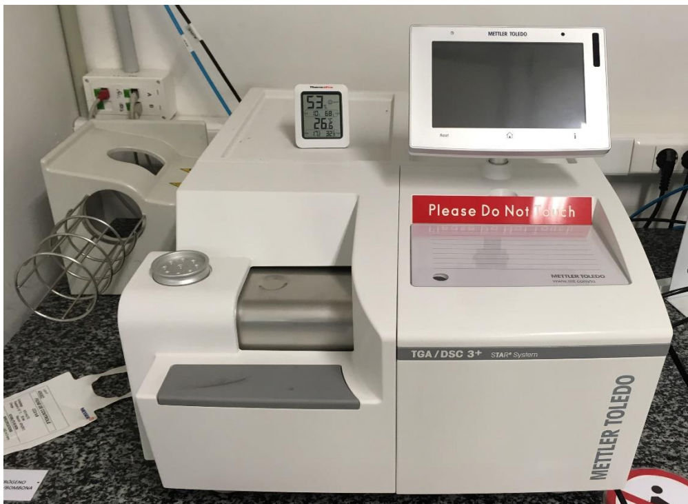
Figura1.6. Apparecchiatura per le analisi termiche (Mettler Toledo TGA/DSC3+)
