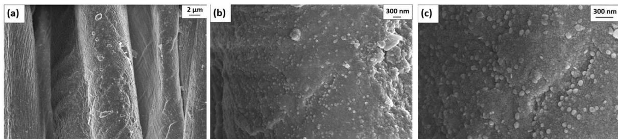
Figura 24 micrografie SEM del coating  $\text{SiO}_2\text{-Ag}_5$  depositato su cotone, a diversi ingrandimenti: (a)10'000X (b) 50'000X (c) 100'00X
