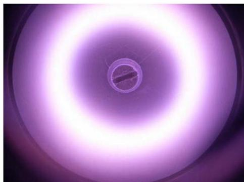
Figura 8 immagine reale del plasma toroidale che si origina all'interno del magnetron sputtering [48].
