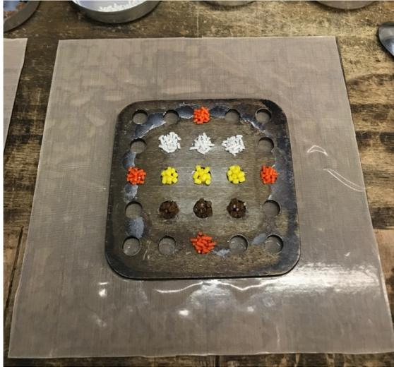
**Figura 3. 1:** Preparazione dei provini per prove di durezza Shore D. Stampo a compressione di Ecogenius PLA (rosso), Shogun Heat Resistant PLA (bianco), Pro PLA (giallo) e Wound Up coffee-Filled PLA.
