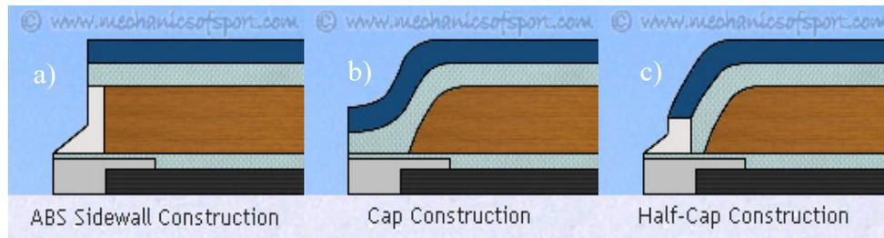
Figura 1.6: possibili tipologie di layup del profilo laterale dello snowboard [4]
