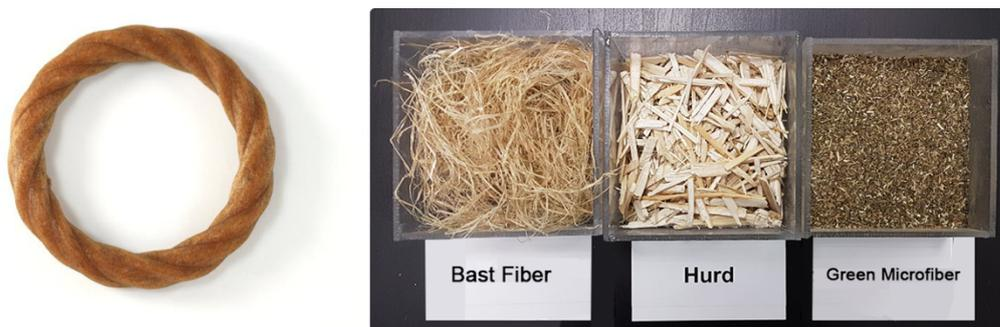
**Figura 2.14:** A sinistra, oggetto decorativo realizzato con Entwined Hemp-Filled PLA da 3D-Fuel [37] (Brochure Entwined Hemp-Filled PLA), a destra prodotti della lavorazione della canapa nell'azienda canadese Greenfield: fibre, canapulo e microfibre [38].
