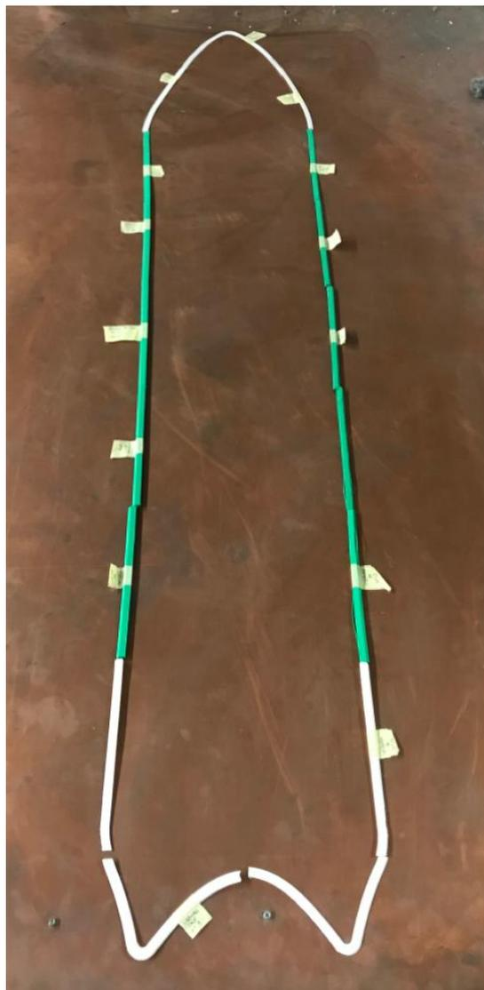
**Figura 5.5:** disposizione dei particolari costituenti il sidewall pronti per l'assemblaggio con il core.
