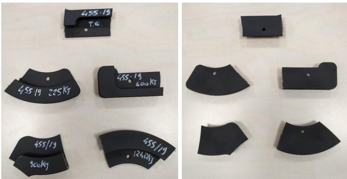
Figura 4.26: Campioni sottoposti al test dell'invecchiamento alla luce artificiale.
