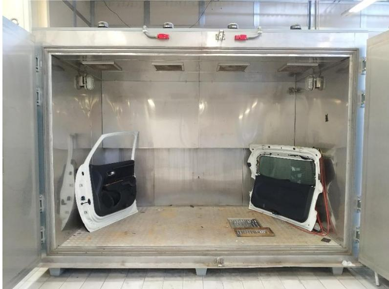
**Figura 3.23:** Componenti in assetto vettura e provini nella cella climatica.
