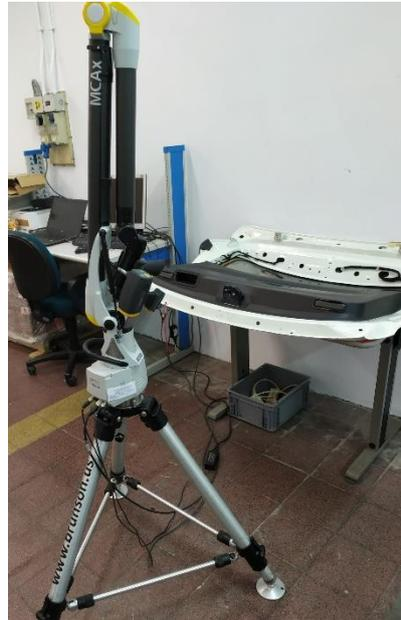
**Figura 3.22:** Laser scanner Nikon MMDx100, prima di una misura sui supporti LED del portellone.
