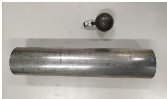
**Figura 3.19:** Sfera e guida cilindrica utilizzati nella prova di impatto a freddo.
