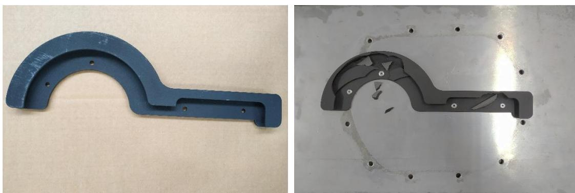
**Figura 4.30:** Componente porta-paletta in configurazione libera (a sinistra) e vincolato ad una piastra metallica (a destra) dopo il test di impatto a freddo.
