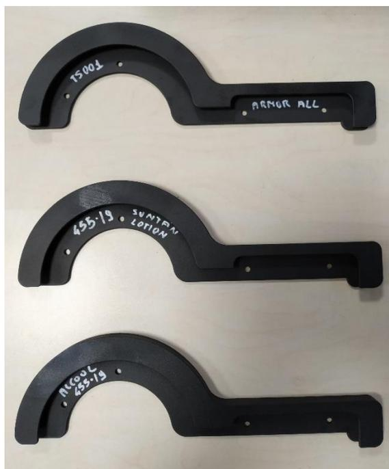
**Figura 4.28:** Componenti esposti ai test di resistenza ai fluidi.
