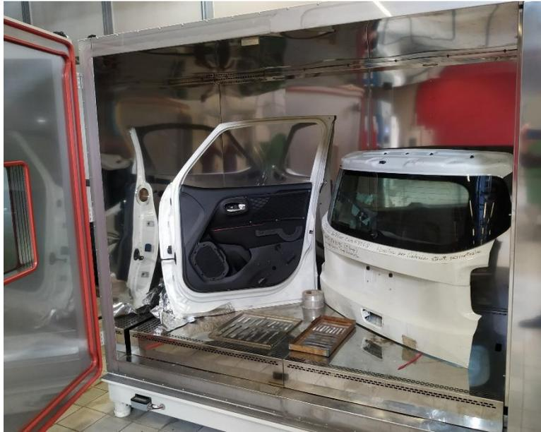
**Figura 3.26:** Componenti in assetto vettura e provini nella cella per cicli termici.
