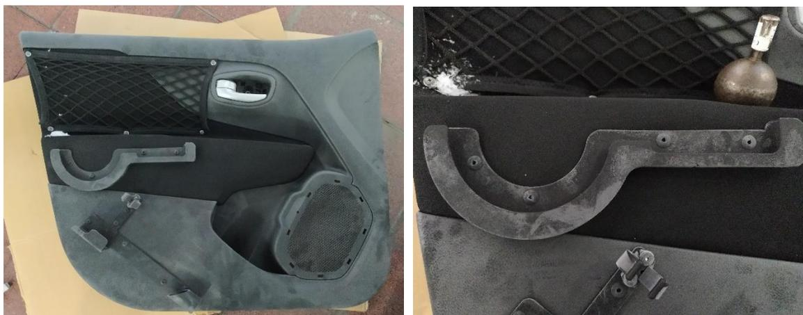
**Figura 4.29:** Pannello porta (a sinistra) con dettaglio del componente porta paletta (a destra), dopo l'esecuzione del test di impatto a freddo.
