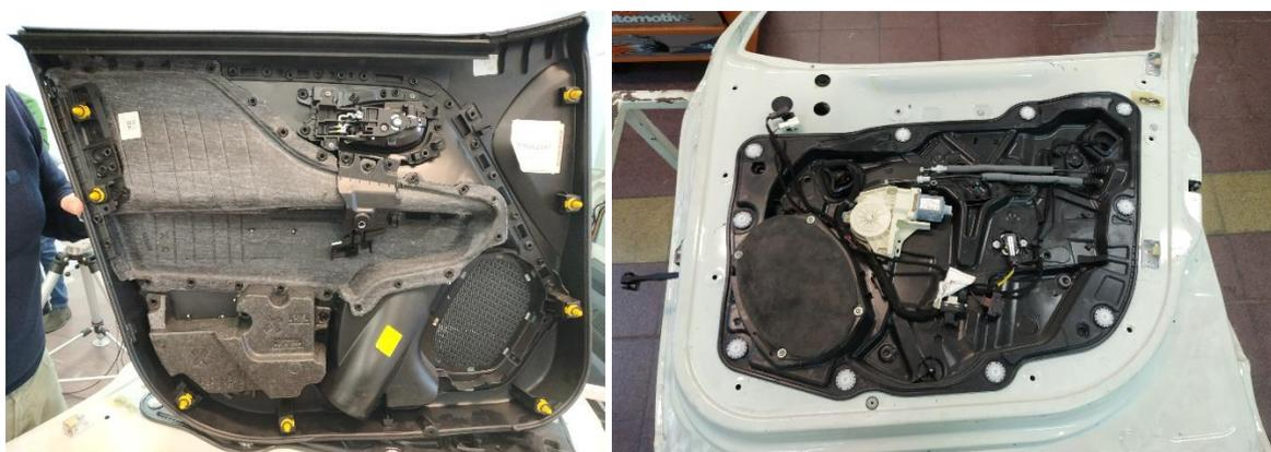
**Figura 3.20:** Fasi iniziali del montaggio del pannello porta: a sinistra – retro del pannello porta; a destra scocca della porta allestita con i componenti elettronici.
