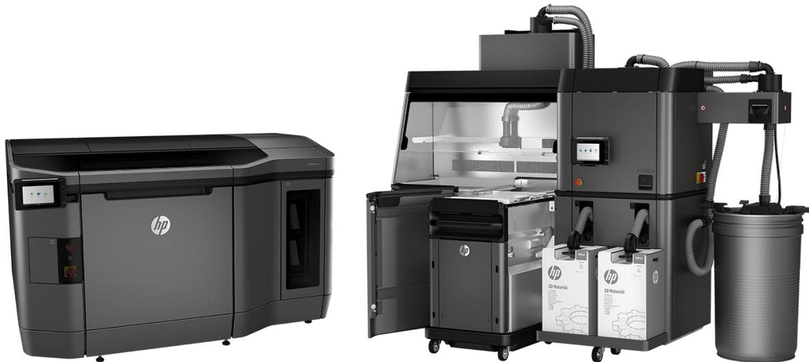
**Figura 2.7:** Apparato del sistema HP Jet Fusion 3D 4200. Da sinistra: stampante, stazione di processo, contenente la build unit (in basso) (Fonte: Prototek, 2017).
