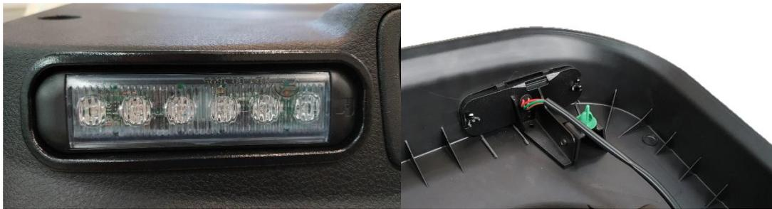
**Figura 3.10:** Vista frontale di un supporto per LED (a sinistra) e retro all'interno del pannello (a destra).
