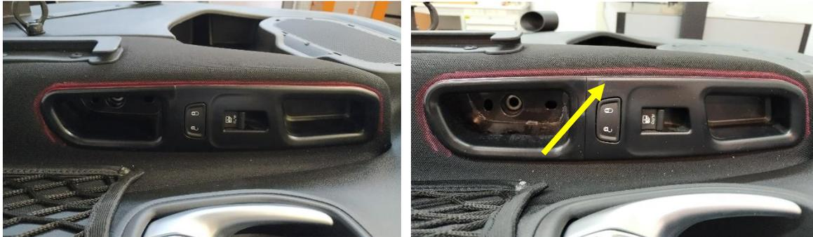
**Figura 4.35:** Tastiera del pannello porta prima e dopo il test di esposizione al caldo umido.
