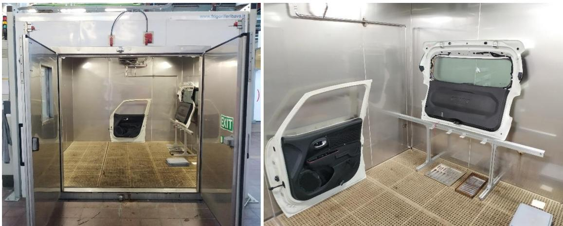
**Figura 3.24:** Componenti in assetto vettura e provini all'interno della cella umidostatica.
