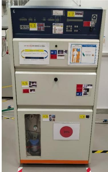
**Figura 3.16:** Camera per invecchiamenti alla luce Q-Lab Q-Sun Xe-3.
