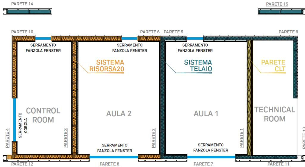
Figura 26. Particolare planimetria con differenziazione del sistema di isolamento utilizzato[8]
