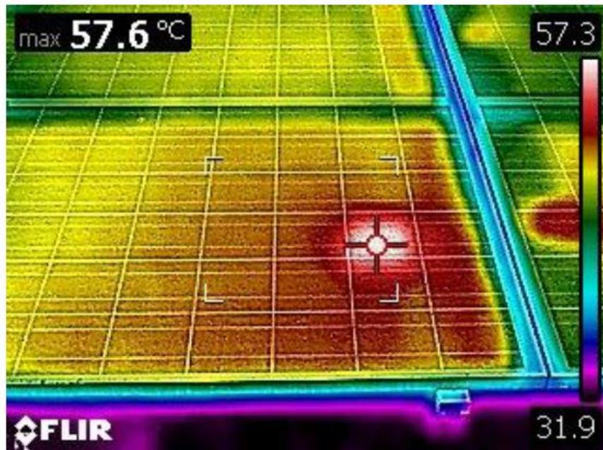
Figura 14 Hot Spot su modulo fotovoltaico da 220 Wp (IR SCAN)
