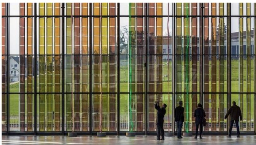
**Figura 11** Moduli FV solari colorati sviluppati da Fraunhofer ISE [29]
