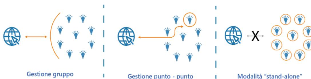
Figura 7 - Modalità di gestione dei punti luce (Fonte: [www.smartlightingproject.it](http://www.smartlightingproject.it))
