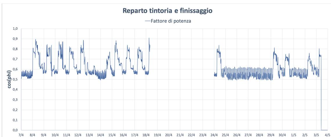
Figura 4.52: Reparto tintoria e finissaggio - fattore di potenza
