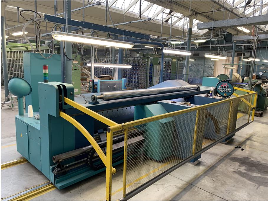
Figura 2.11: Reparto orditura - orditoio sezionale moderno
