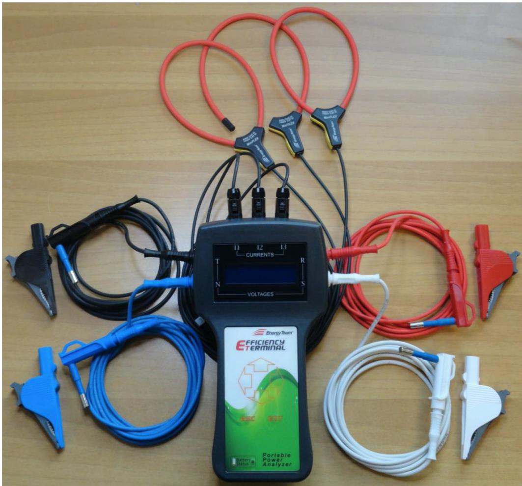
Figura 4.13: Analizzatore di rete portatile
