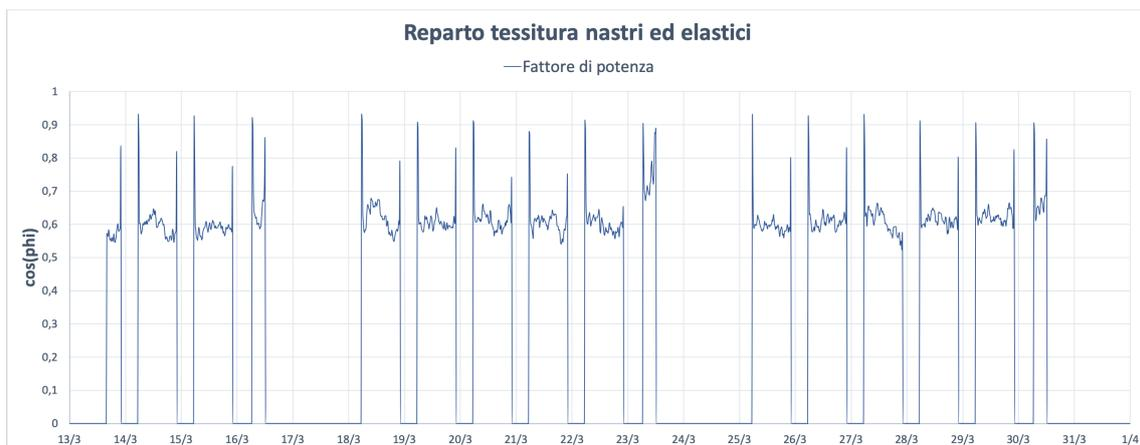
Figura 4.51: Reparto tessitura nastri ed elastici - fattore di potenza
