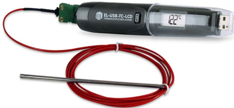
Figura 4.4: Datalogger da termocoppie
