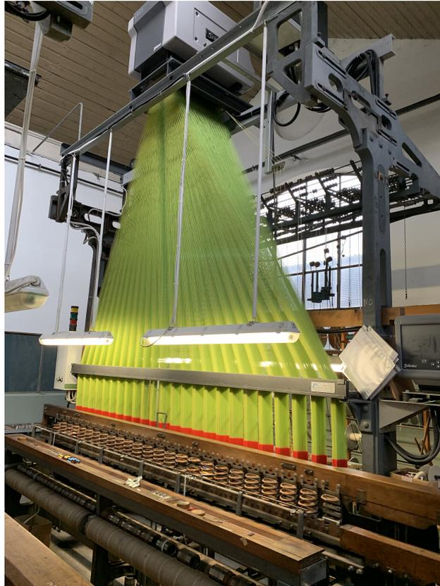
Figura 2.23: Reparto tessitura navette - telaio movimentato digitalmente
