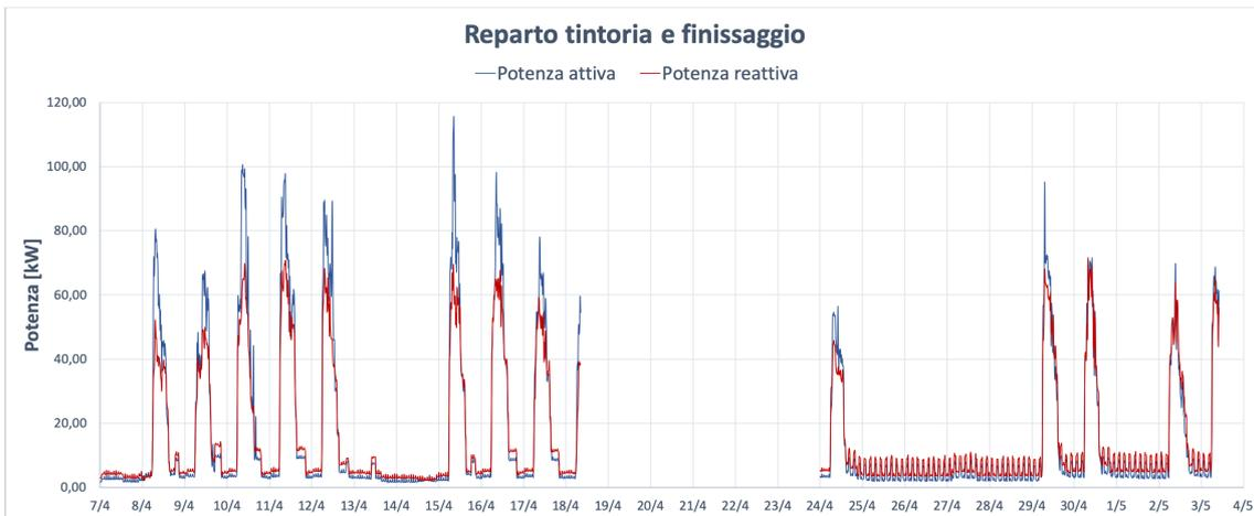
Figura 4.47: Reparto tintoria e finissaggio - Potenza elettrica
