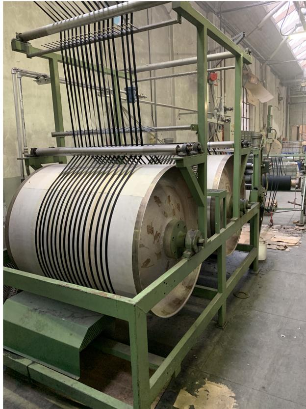
Figura 2.27: Reparto finissaggio - calandre a vapore
