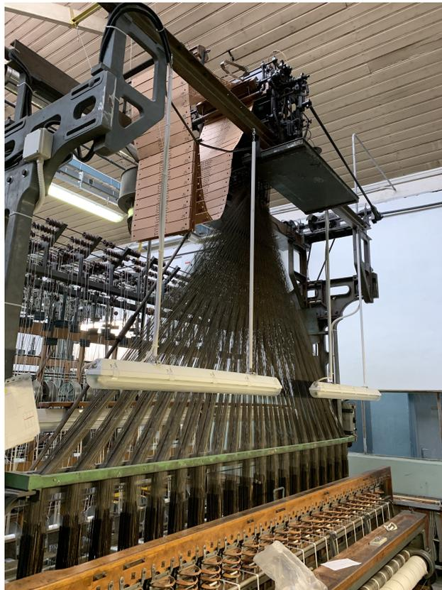
Figura 2.22: Reparto tessitura navette - telaio movimentato da cartoni forati
